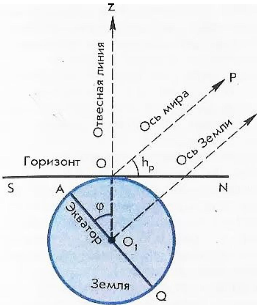
Ось Земли  $\perp$  экватору, а ось мира  $OP$  параллельна оси Земли,
