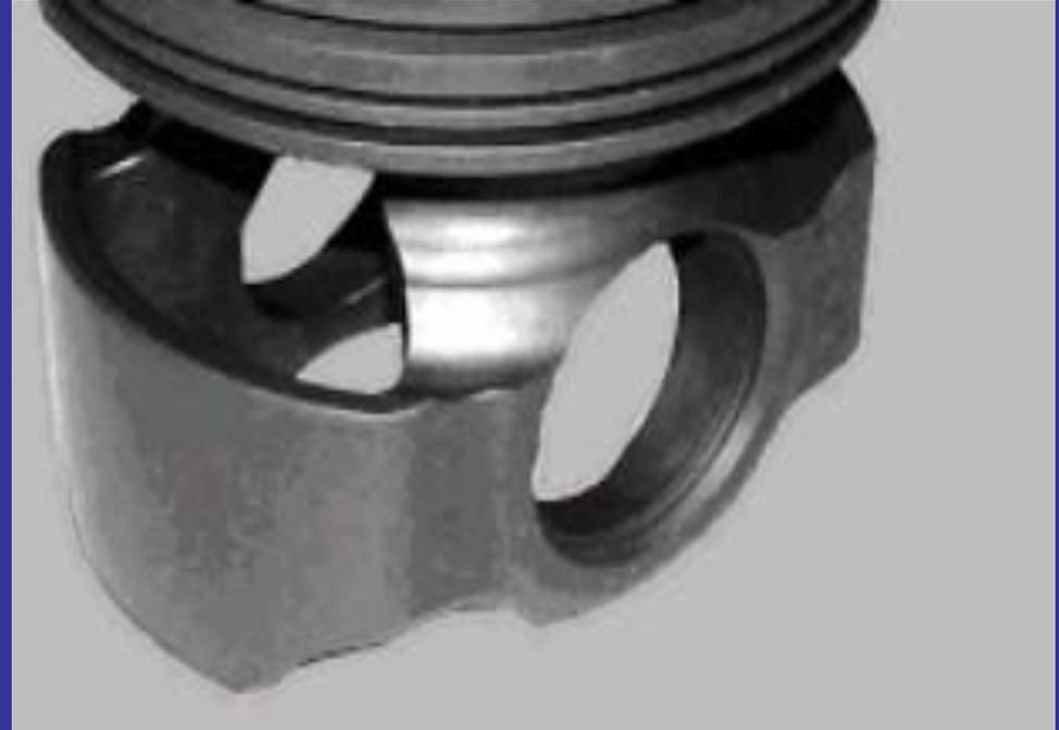
Предохранять от очистки юбку покрытую графитом и отверстия бобышек
