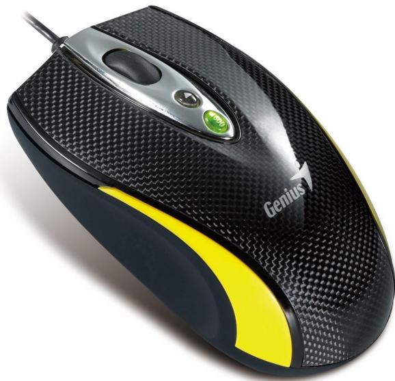
У мыши могут быть одна, две или три клавиши. Между двумя крайними клавишами современных мышей часто располагают **скрол**. Это дополнительное устройство в виде колесика, которое позволяет осуществлять прокрутку документов вверх-вниз и другие дополнительные функции.
