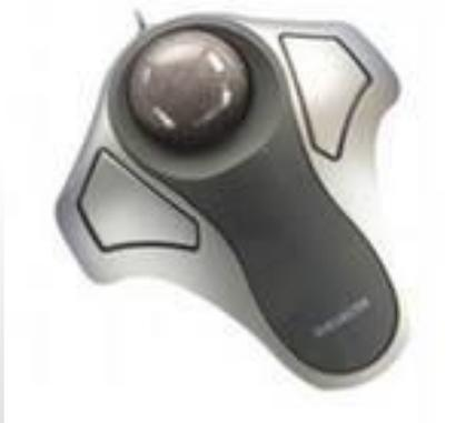
**Трекбол** по функциям близок мыши, но шарик в нем больших размеров, и перемещение указателя осуществляется вращением этого шарика руками. Трекбол удобен тем, что его не требуется перемещать по поверхности стола, которого может не быть в наличии. Поэтому, по сравнению с мышью, он занимает на столе меньше места. Большинство переносных компьютеров оснащаются встроенным трекболом.
