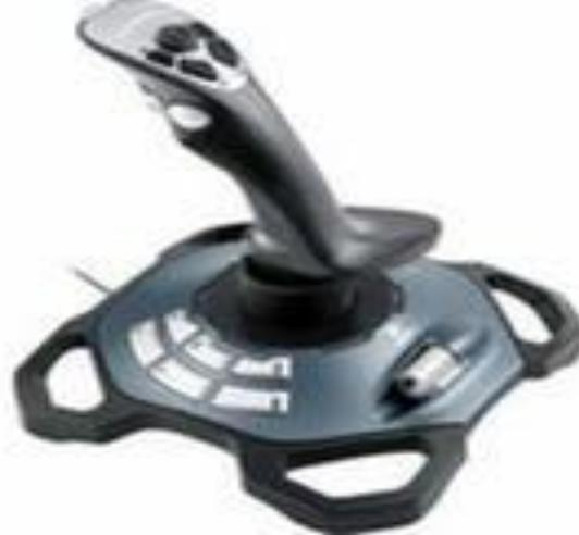
**Джойстик** представляет собой основание с подвижной рукояткой, которая может наклоняться в продольном и поперечном направлениях. Рукоятка и основание снабжаются кнопками. Внутри джойстика расположены датчики, преобразующие угол и направление наклона рукоятки в соответствующие сигналы, передаваемые операционной системе. В соответствии с этими сигналами осуществляется перемещение и управление графических объектов на экране.
