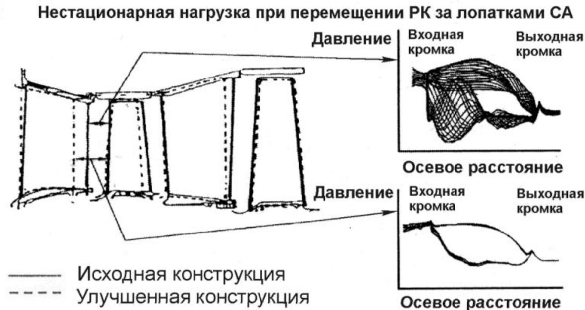
Здесь показано влияние перепроектирования проточной части двухступенчатой ТВД с увеличением осевого зазора между сопловой и рабочей лопатками. Увеличение зазора позволило существенно уменьшить колебания статического давления (и скорости) на профиле рабочей лопатки с увеличением аэродинамической эффективности турбины примерно на 0.3%.
