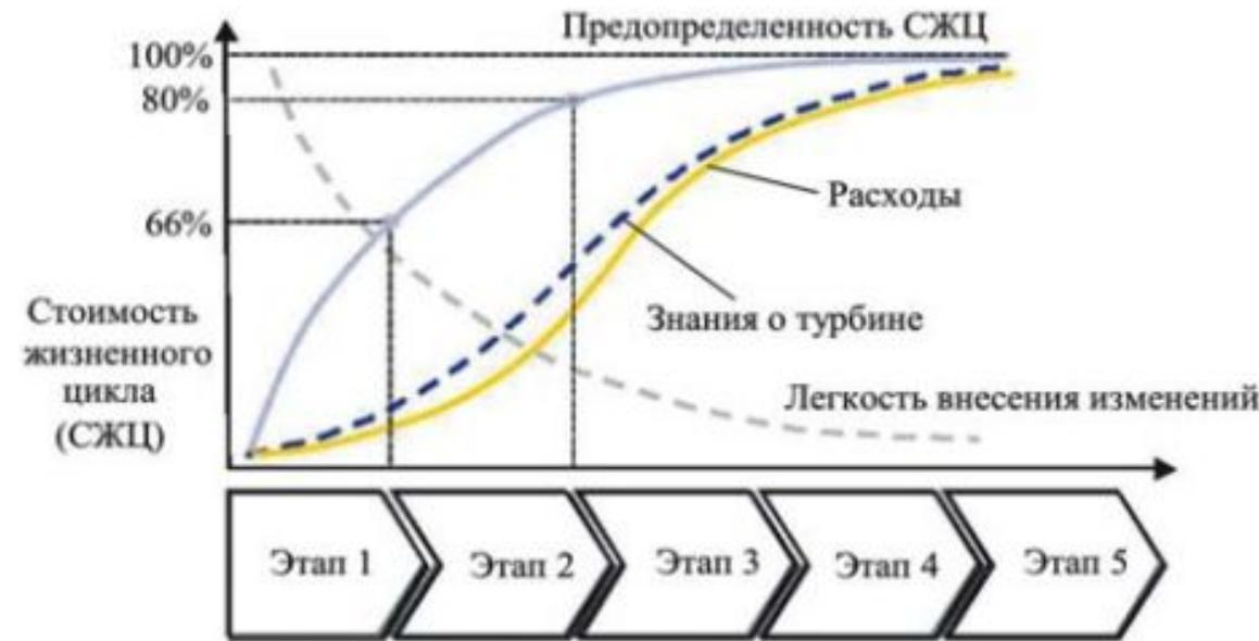
Этап 1 – предварительное проектирование; этап 2 – проектирование и испытания; этап 3 – производство; этап 4 – эксплуатация; этап 5 – списание
