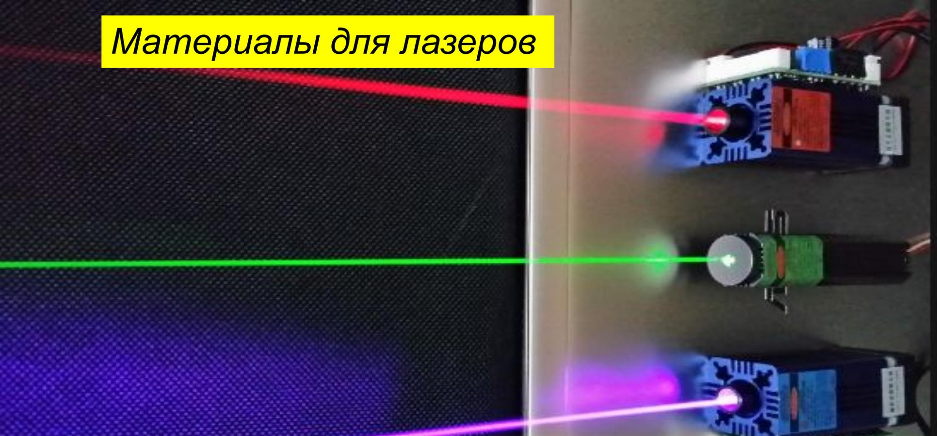
*Возможность варьирования длины волны люминесценции принципиальное преимущество для создания новых лазерных сред. В существующих лазерах длина волны люминесценции является фундаментальной характеристикой среды и возможности ее варьирования ограничены (лазеры с перестраиваемой длиной волны используют свойства резонаторов и более сложные эффекты). Другое преимущество квантовых точек – высокая фотостойкость по сравнению с органическими красителями.*
