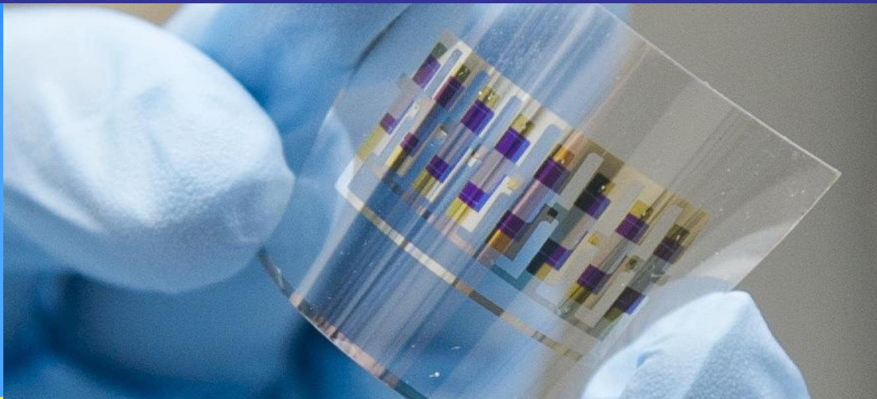
*В 2005 г. К. Мюрреем и Д. Талапиным сообщено о создании тонкопленочного полевого транзистора на основе квантовых точек селенида свинца  $PbSe$  с использованием молекул гидразина  $N_2H_4$  для пассивации поверхности.*
