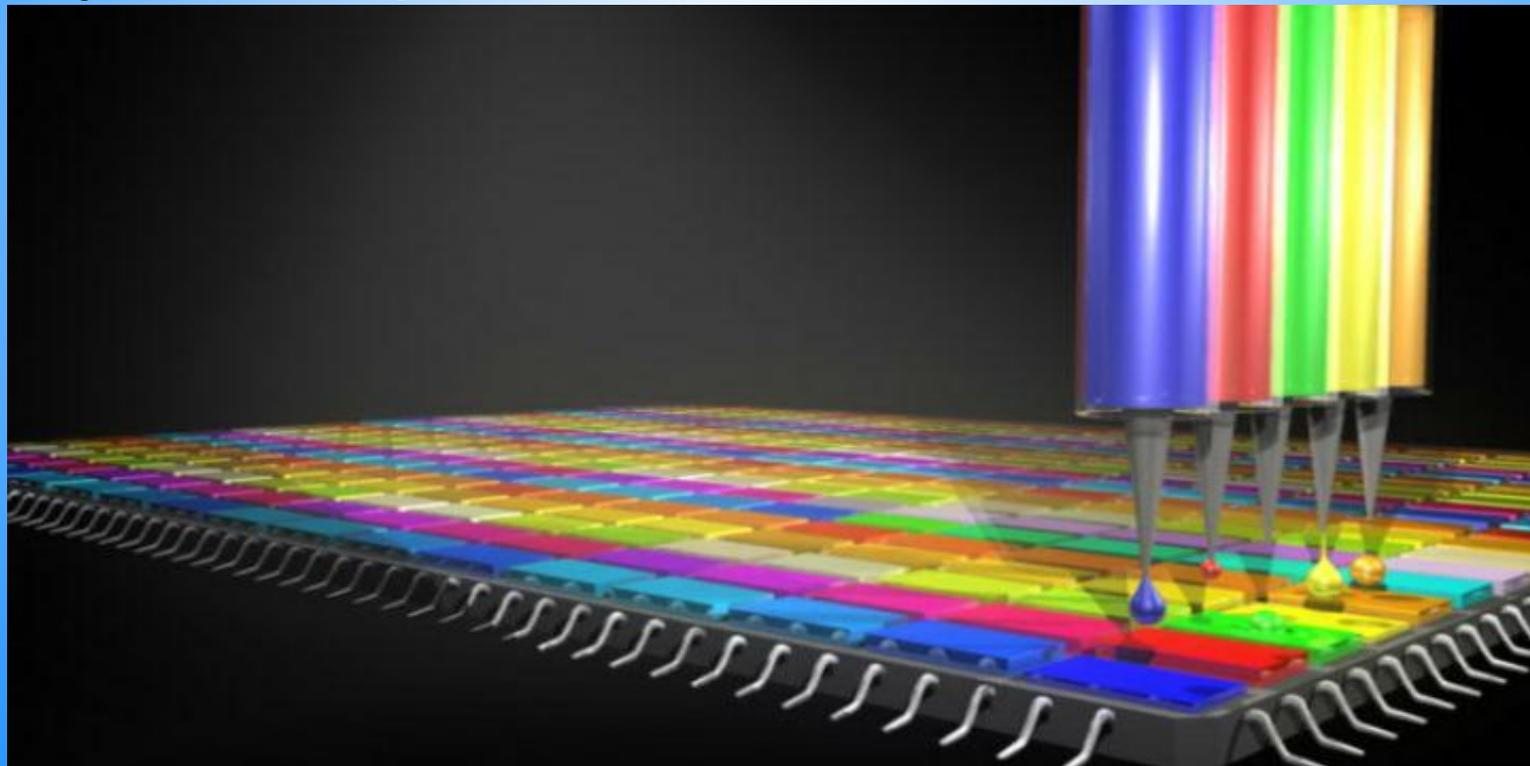
*Таким образом избегаем, при создании устройств на основе квантовых точек, дорогих вакуумных технологий, которые обычно используют для микроэлектронной техники.*
