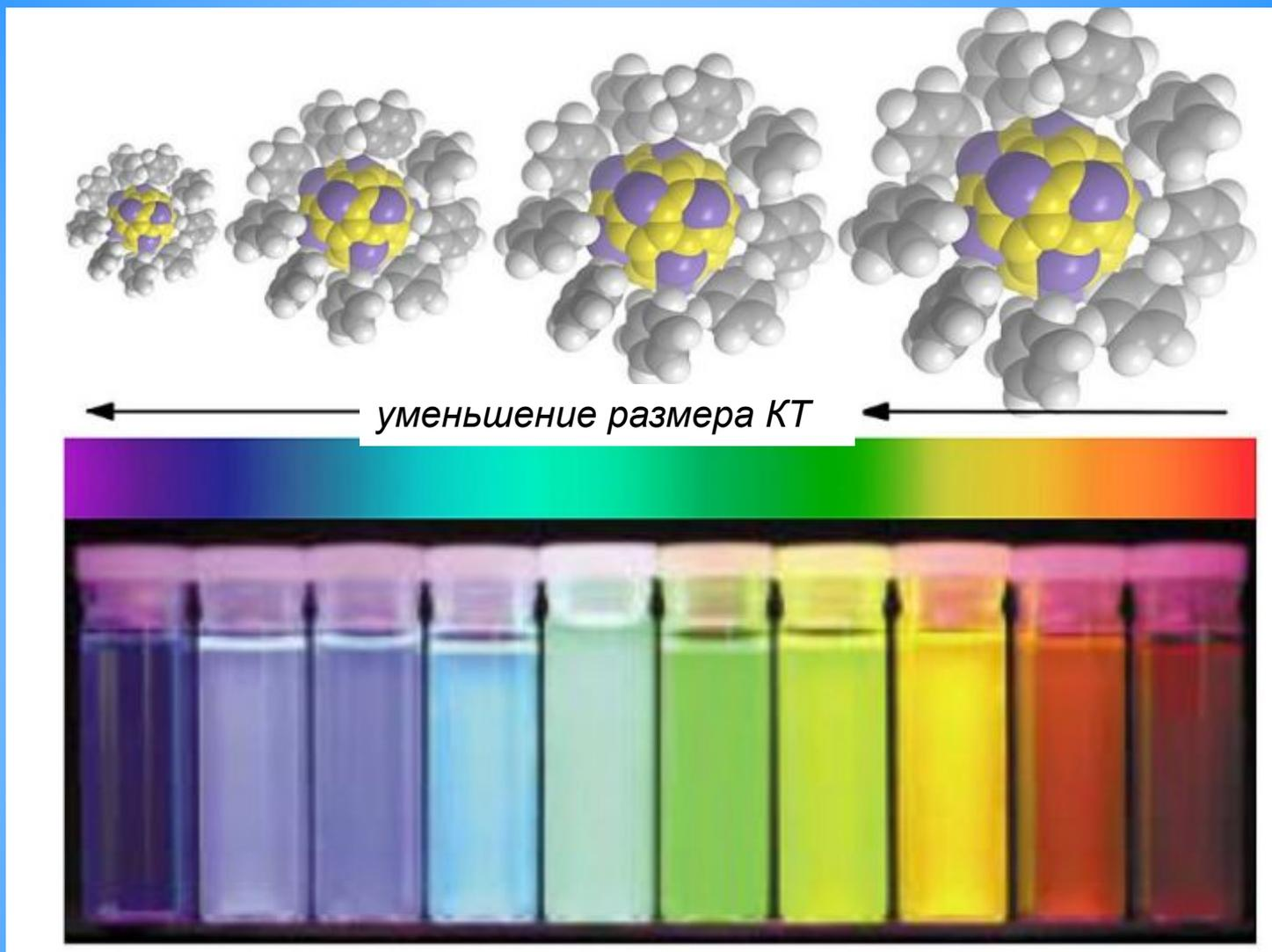
Изменение цвета коллоидного раствора частиц селенида кадмия -  $\text{CdSe}$  в оболочке селенида цинка -  $\text{ZnSe}$  в зависимости от размера квантовых точек.
