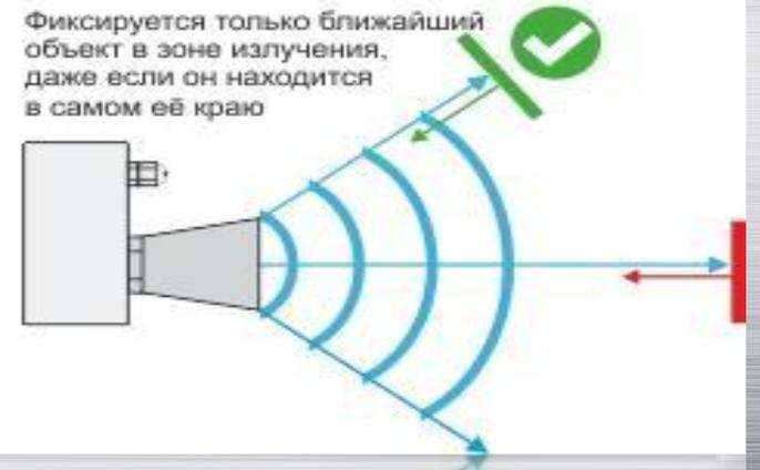
**В результате, после обработки сигнала, включается реле тревоги. В качестве излучателя и приёмника используются элементы из пьезокерамики.**
