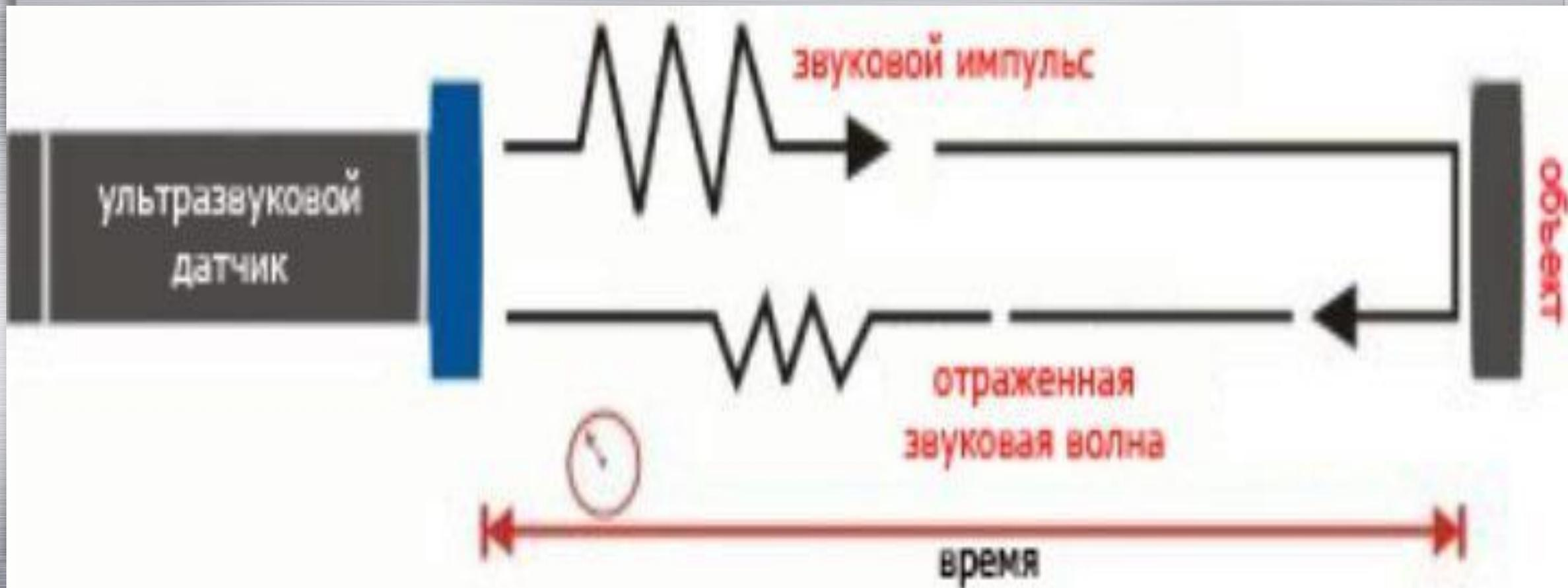
Основу такого датчика составляет звуковой генератор, вырабатывающий колебания с частотой порядка 25-40 КГц.
