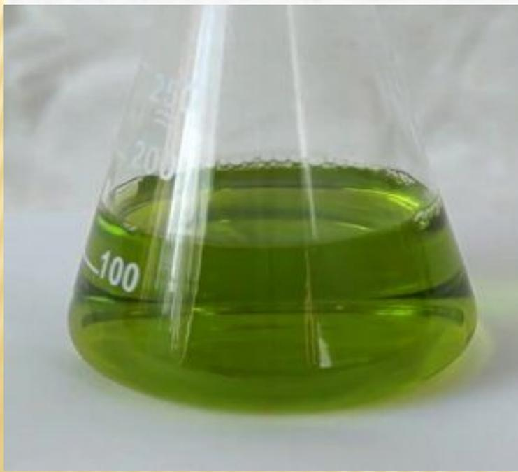
**Растворитель: безводная уксусная кислота, индикатор: раствор метилового фиолетового в безводной уксусной кислоте, который имеет переход окраски от фиолетовой через сине-зеленую (нейтральная) до желтовато-зеленой**
