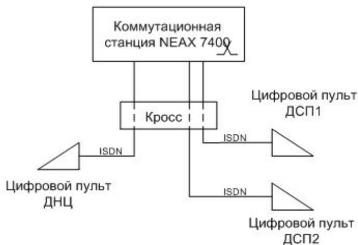
Структурная схема организации прямой связи между абонентами одной станции
