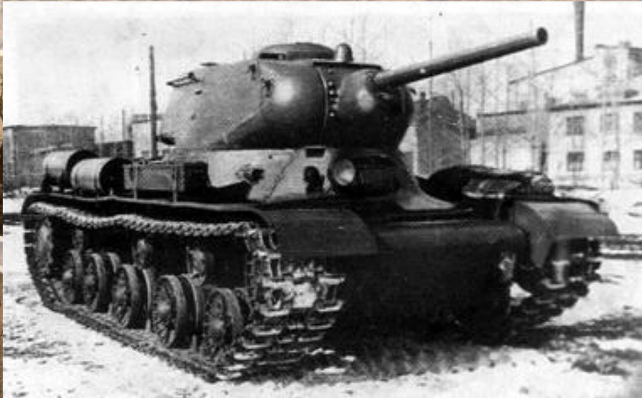
**Опытный тяжёлый танк ИС (1942 г.).**
