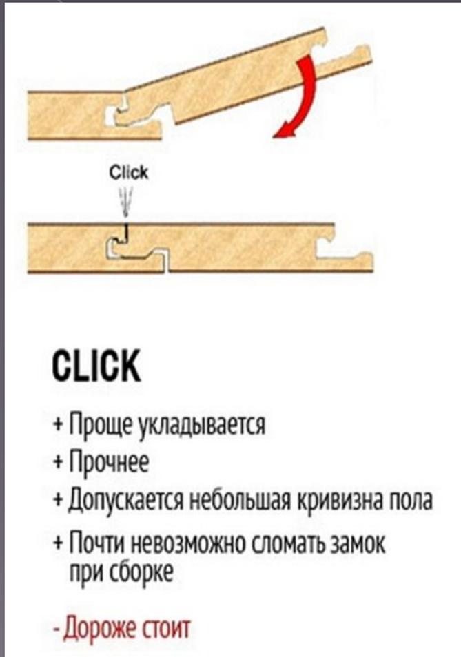
Ламинат в этом случае отличается более сложной конструкцией. Однако сборка покрытия очень проста, поэтому осуществить ее сможет даже тот человек, который ни разу не держал в руках молоток. Особенностью планок является то, что соединяются они под некоторым углом - 45 градусов. При этом никаких усилий прикладывать не нужно. Представленный способ соединения дает возможность разобрать покрытие и переместить его в другое помещение.
