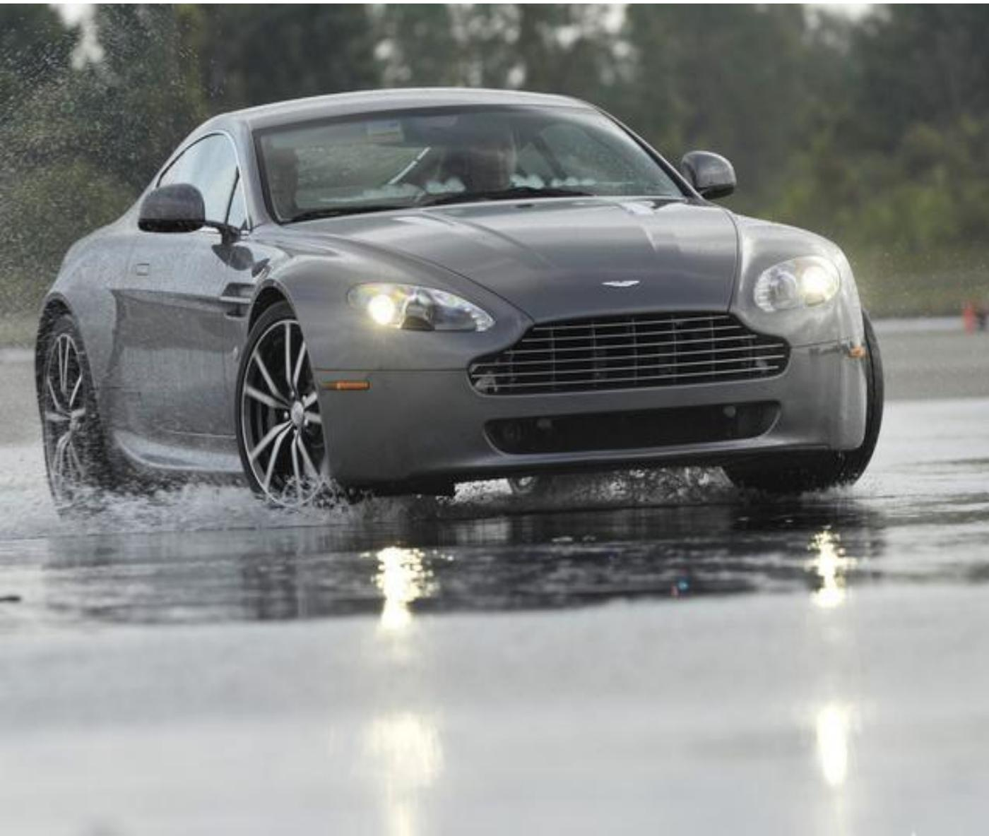
если автомобиль на скорости повело, то информация начинает считываться, практически со всех датчиков, (особенно с датчиков угловой скорости колес), также датчики учитывают величину крутящего момента двигателя. Если двигатель имеет высокие обороты, то система автоматически понижает их, что позволяет избежать пробуксовки колес. Нужно отметить, что система не блокирует обороты до нуля, а просто понижает их! Это позволяет уверенно двигаться автомобилю даже в плохие погодные условия (дождь, снег).
