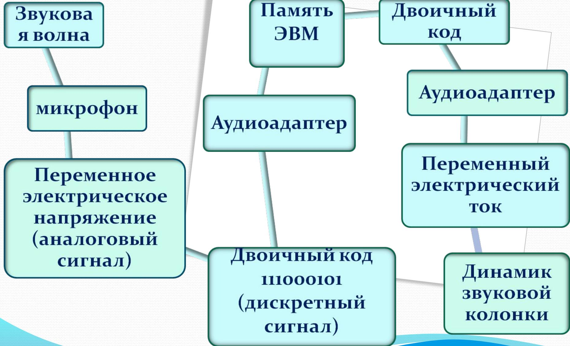
Так каков же принцип кодирования звуковой информации, какие функции выполняет аудиоадаптер?
