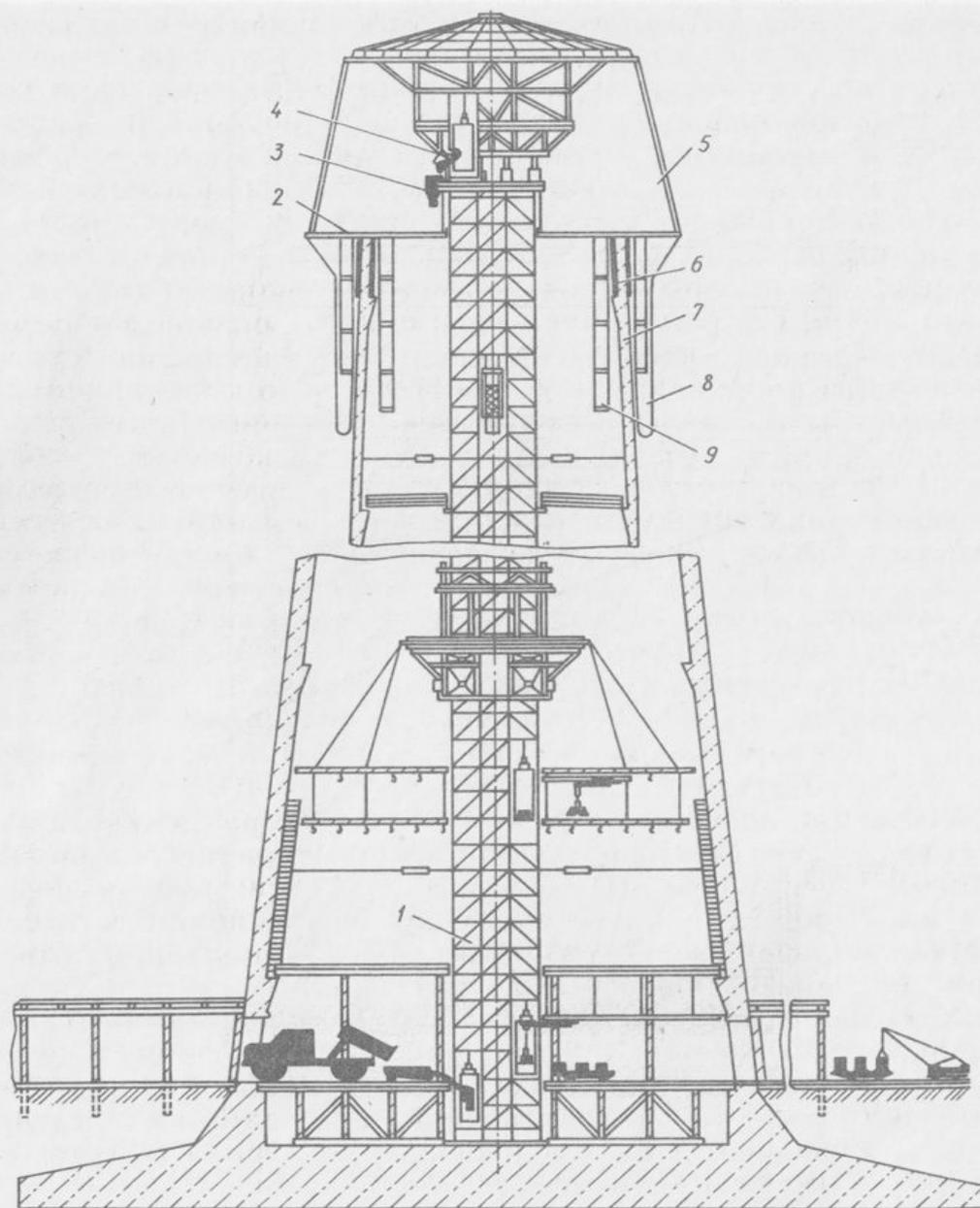
Рис. 35. Схема бетонирования ствола трубы:
