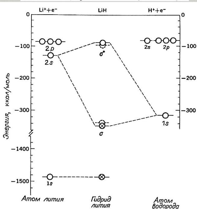
Рис. 3.14. Молекулярные орбитали в гидриде лития LiH.
