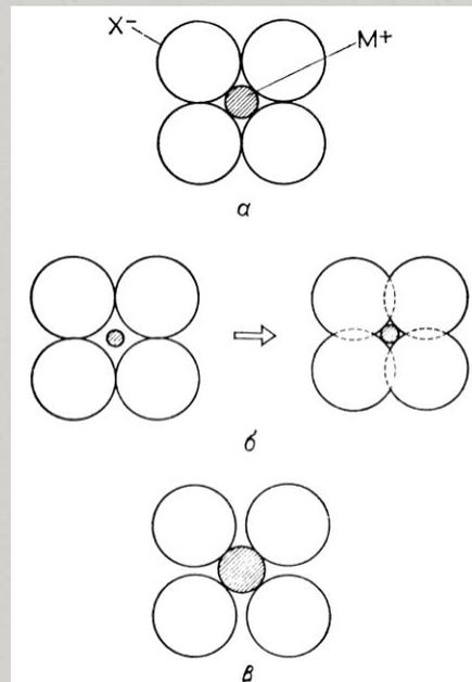
Рис. 8.40. Влияние относительного размера иона в решетке NaCl.
