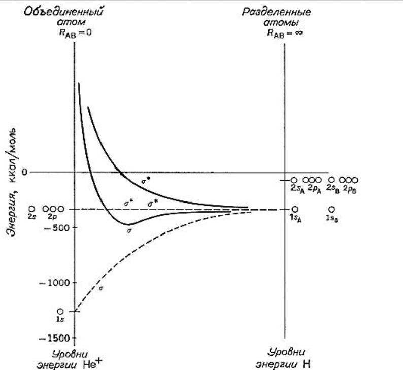
Рис. 3.6. Корреляционная диаграмма для  $\text{H}_2^+$  без учета (---) и с учетом (—) межъядерного отталкивания.
