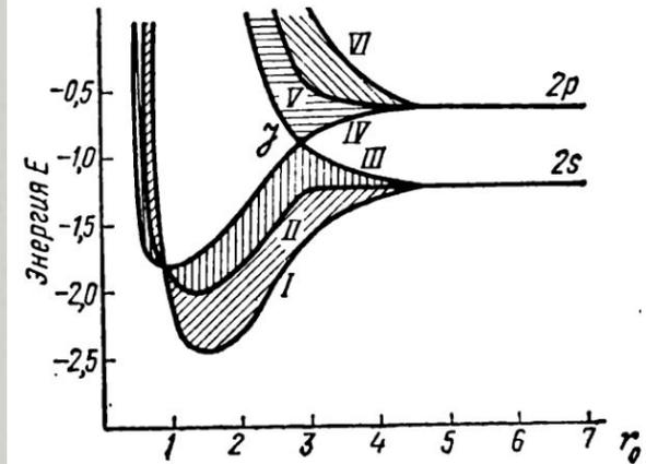
Рис. IV.14. Квантостатическая картина образования графита и алмаза при сближении атомов углерода в зависимости от характера перекрытия энергетических зон на разных межъядерных расстояниях (по Кимболу)
