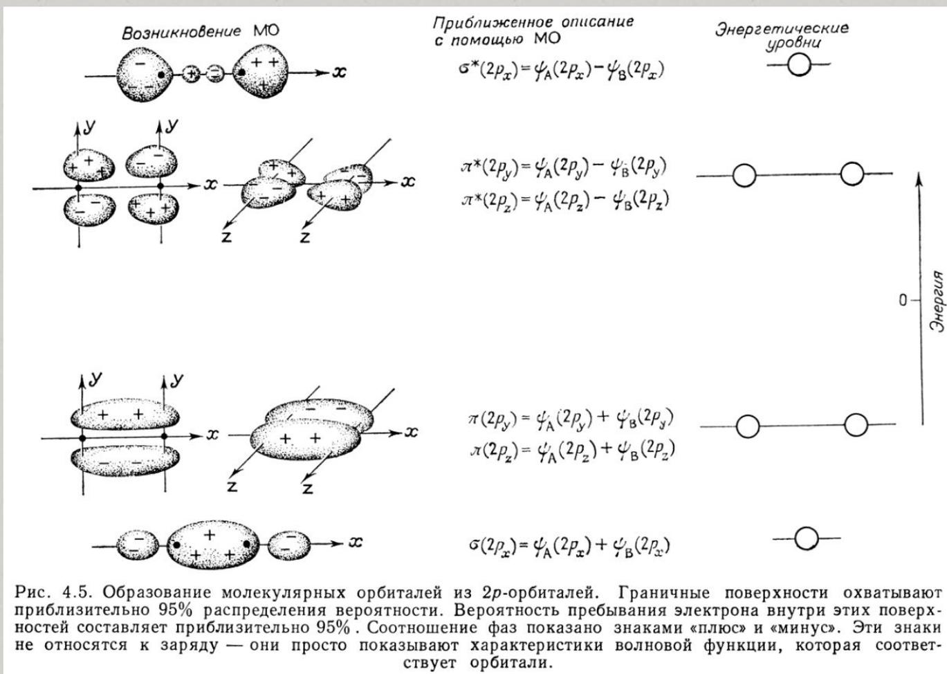
Рис. 4.5. Образование молекулярных орбиталей из 2p-орбиталей. Граничные поверхности охватывают приблизительно 95% распределения вероятности. Вероятность пребывания электрона внутри этих поверхностей составляет приблизительно 95%. Соотношение фаз показано знаками «плюс» и «минус». Эти знаки не относятся к заряду — они просто показывают характеристики волновой функции, которая соответствует орбитали.
