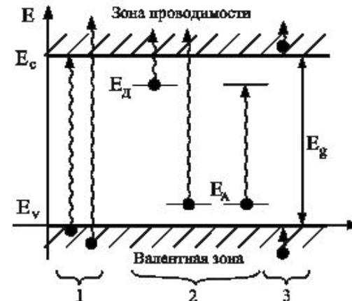
Рис. 4.2. Электронные переходы при оптическом поглощении в полупроводниках:
