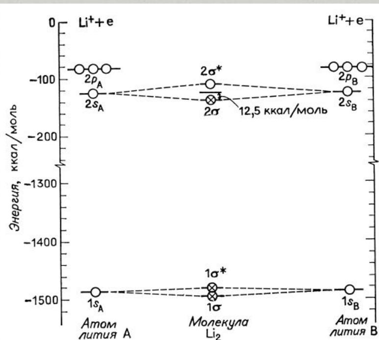
Рис. 3.11. Молекулярные орбитали в молекуле  $\text{Li}_2$ .
