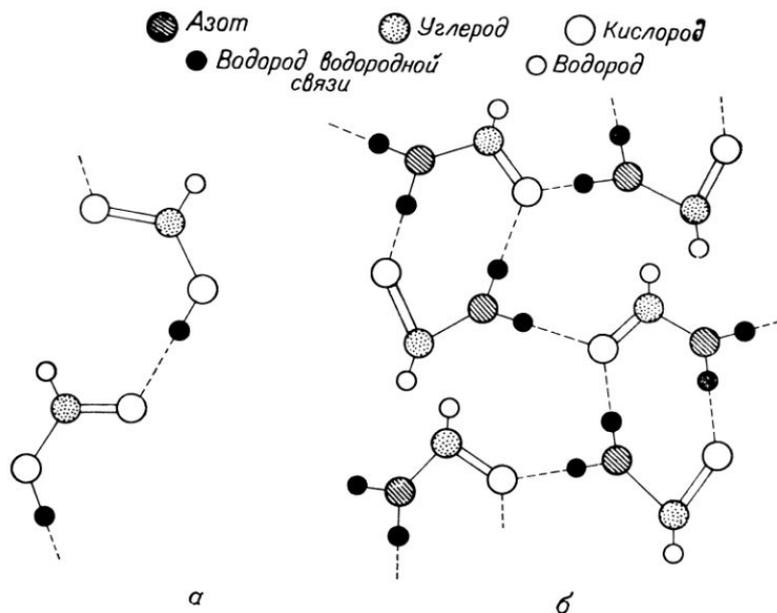
Рис. 8.20. Кристаллические структуры муравьиной кислоты  $\text{HCOOH}$  (а) и формамида  $\text{HCO(NH}_2\text{)}$  (б). Пунктирными линиями обозначены водородные связи.
