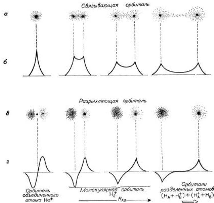
Рис. 3.5. Эволюция орбиталей при разделении  $\text{He}^+$  на два протона и электрон. а и в — распределение вероятности; б и г — значения и фазы функции. (На диаграмме распределения вероятности изменение фазы показано светлыми и темными областями соответственно.)
