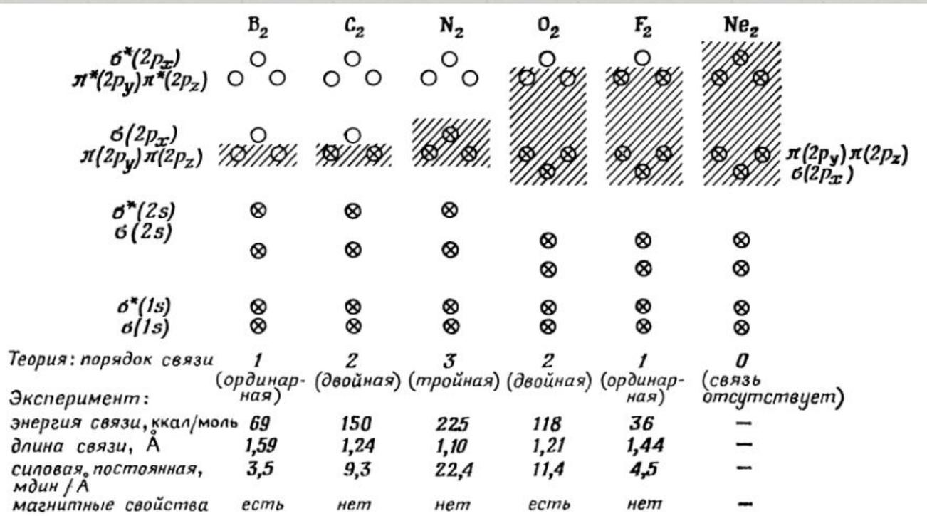
Рис.4.11. Орбитальные заселенности и свойства связи в гомоядерных двух-атомных молекулах элементов второго периода.
