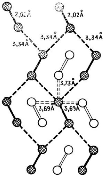
Рис. 8.8. Кристаллический хлор: молекулярный кристалл.
