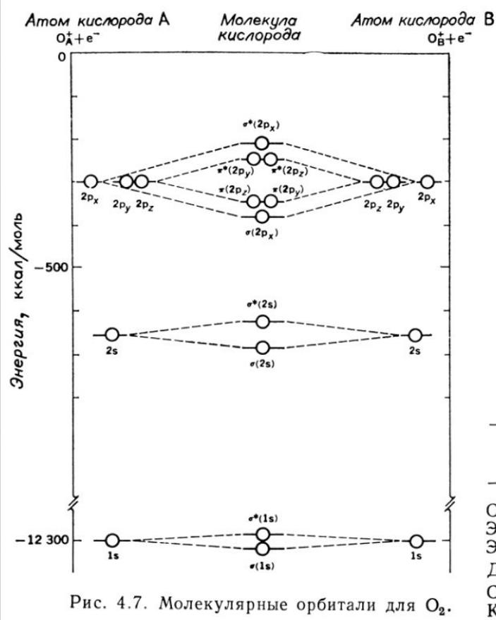
Рис. 4.7. Молекулярные орбитали для O<sub>2</sub>.
