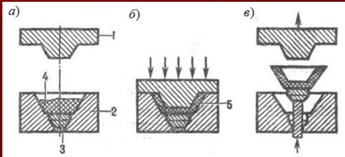
Рис. 7. Схема изготовления ПНК прессованием:
