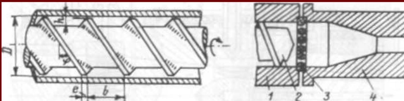
Рис. 4. Схема шнека экструдера
