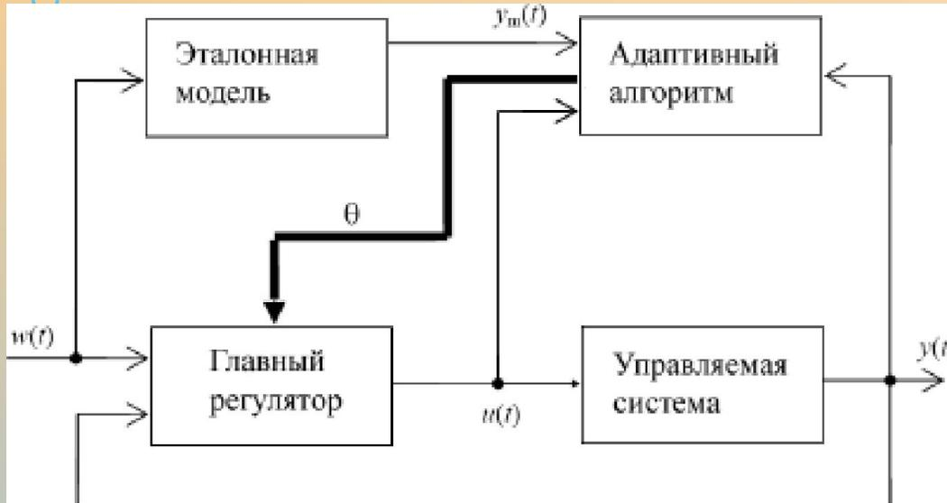
**Адаптивные системы с эталонной моделью.** Такие системы работают по принципу прямого адаптивного управления.
