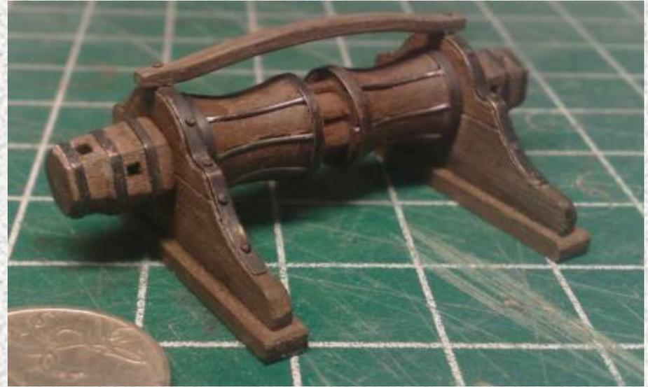
**Брашпиль - лебёдка с горизонтальным валом и двумя барабанами, применяемая на судах для подъёма якорной цепи и якоря, а также для швартовки.**
