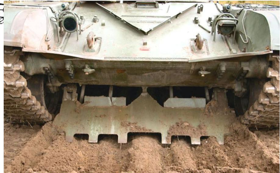
**Отвал** предназначен для резания грунта и его перемещения.
