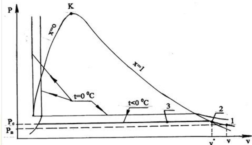
Рис. 7.10. Состояния H<sub>2</sub>O в атмосферном влажном воздухе при  $t < 0$  °С в P, v - диаграмме
