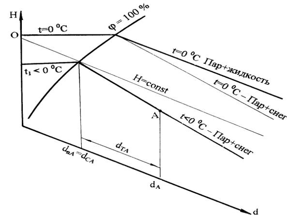
Рис. 7.9. К определению параметров перенасыщенного влажного воздуха по H, d - диаграмме при  $t < 0$  °С
