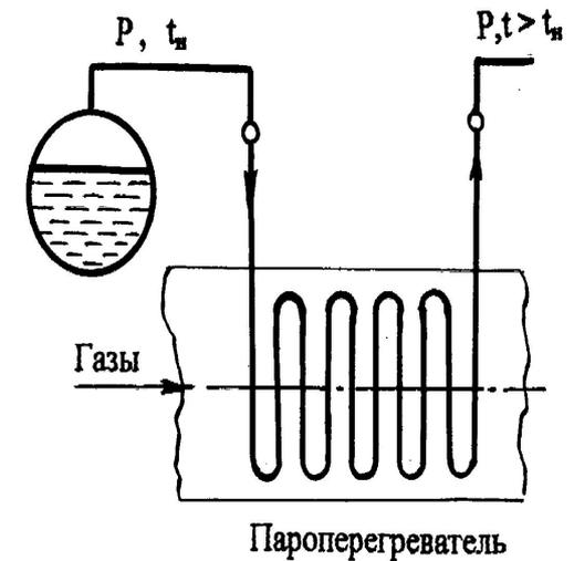
Рис. 6.17. Схема пароперегревателя
