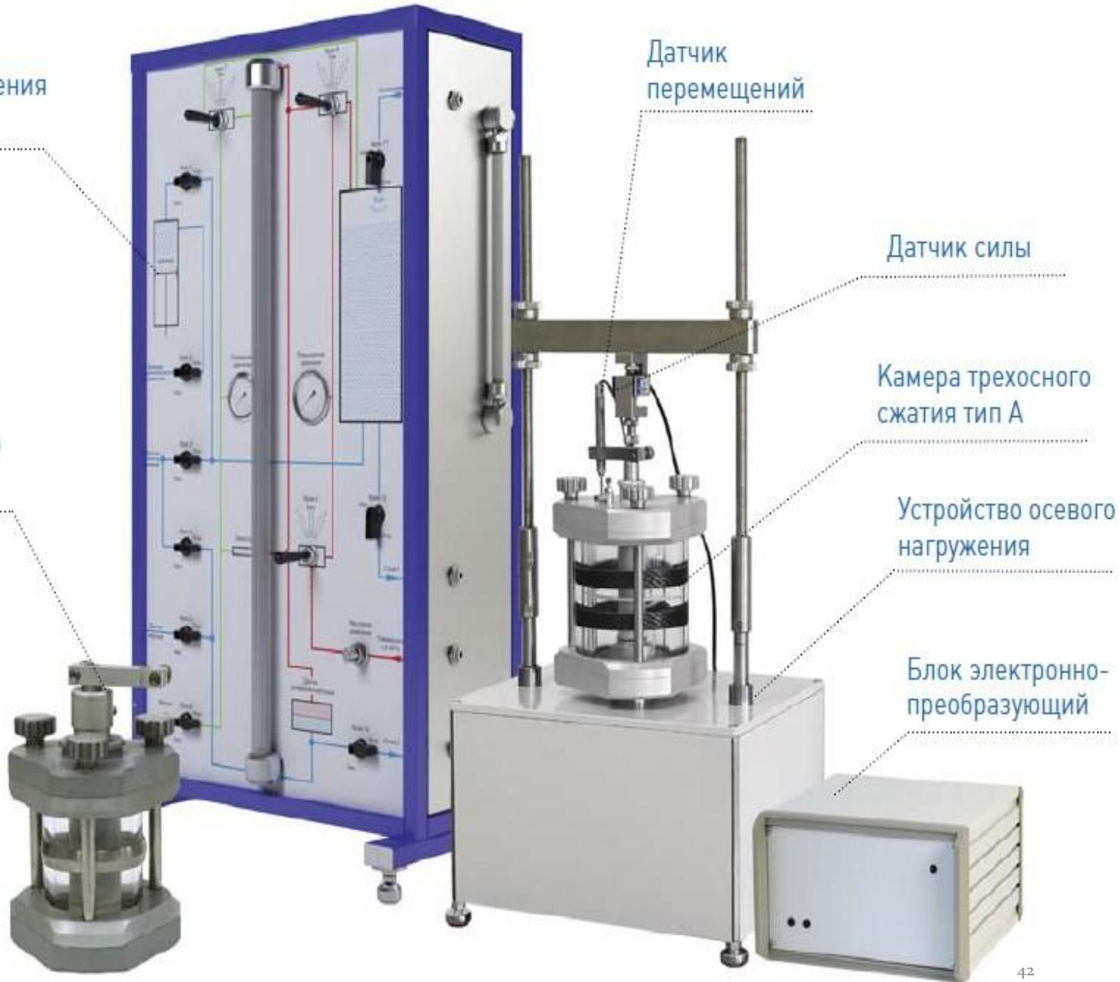
С целью приближения лабораторных условий к естественным используют прибор для трехосного сжатия **стабилометр**
