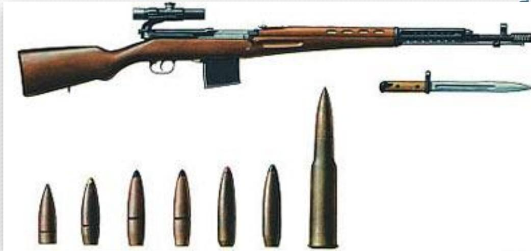
Наряду с самозарядной винтовкой, Токарев разработал на ее базе автоматическую винтовку обр. 1940 г. (АВТ-40), выпускавшуюся в 1942 году. Ее ударно-спусковой механизм позволял вести одиночный и непрерывный огонь. Роль переводчика вида огня выполнял предохранитель. Стрельба короткими очередями решалась только в случае нехватки ручных пулеметов во время напряженного боя. Скорострельность АВТ-40 при стрельбе одиночными выстрелами достигала 20-25 выстр/мин, короткими очередями 40-50 выстр/мин, при
