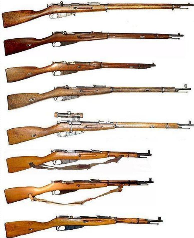
**7,62-мм (3-линейная) винтовка образца 1891 года (винтовка Мосина, трёхлинейка) — магазинная винтовка, принятая на вооружение Российской Императорской армии в 1891 году.**
