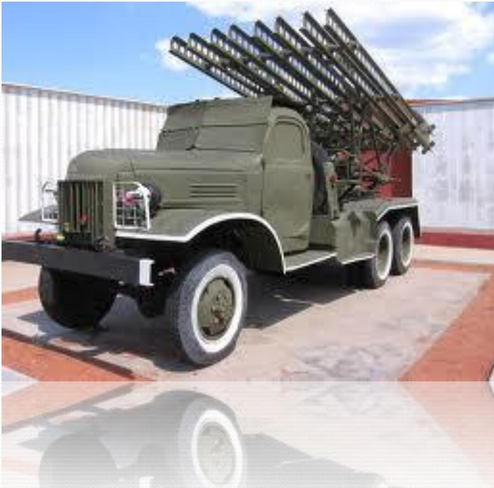
«Катю́ша» — неофициальное собирательное название боевых машин реактивной артиллерии БМ-8 (82 мм), БМ-13 (132 мм) и БМ-31 (310 мм). Такие установки активно использовались СССР во время Второй мировой войны. В 1937—1938 эти реактивные снаряды были приняты на вооружение в Военно-воздушными силами СССР. На каждой машине находился ящик со взрывчаткой и бикфордов шнур. В случае появления риска захвата техники врагом экипаж был обязан взорвать её и тем самым уничтожить
