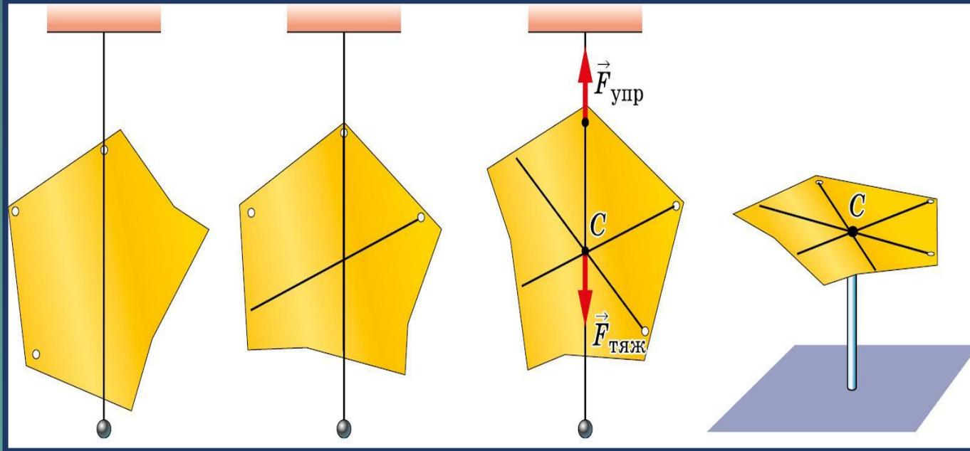
На фигуру действуют две силы: **сила тяжести** и **сила упругости**.
