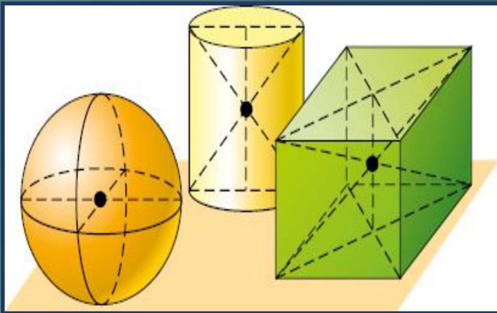
Центр тяжести шара лежит в его геометрическом центре, у цилиндра он находится на середине линии, соединяющей центры его оснований, у параллелепипеда — в точке пересечения диагоналей
