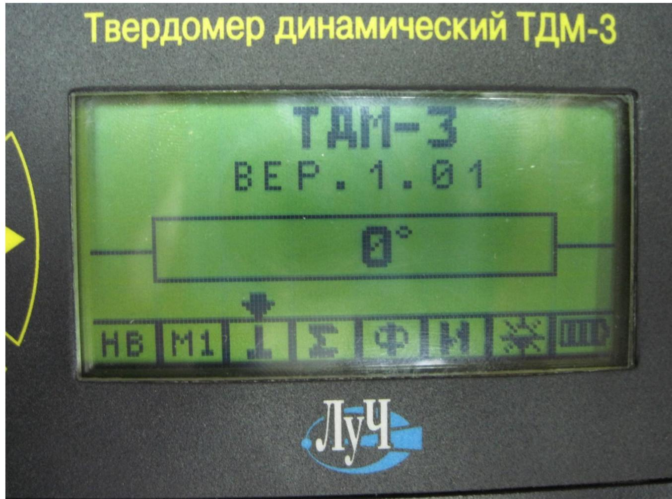
Параметр «Угол наклона преобразователя»
