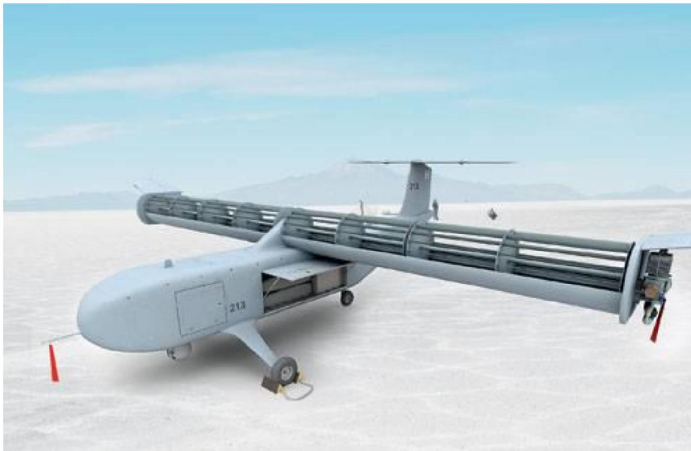
Роторный предкрылок — оригинальный двигатель самолёта представляющий собой особый ротор, расположенный в передней части крыла и создающий подъёмную силу.
