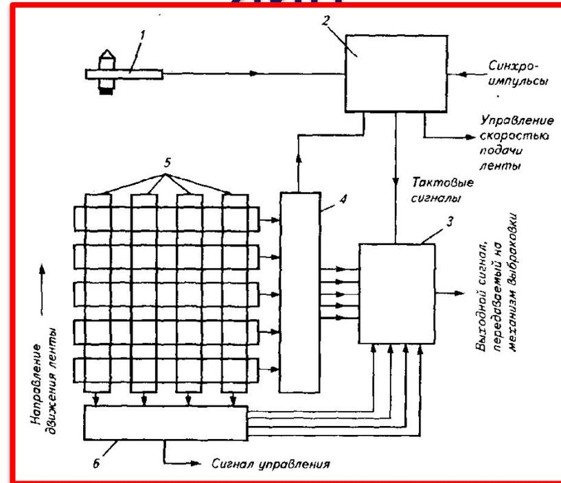
1 — жезл; 2 — схема управления; 3 — регистровая память; 4 и 6 — дешифраторы поперечных и продольных рядов; 5 — матрицы
