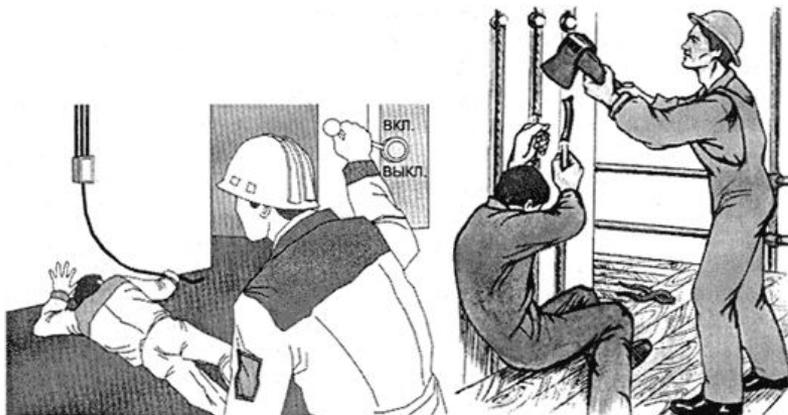
**! Освобождение пострадавшего от действия электрического тока путем перерубания электрического провода**
