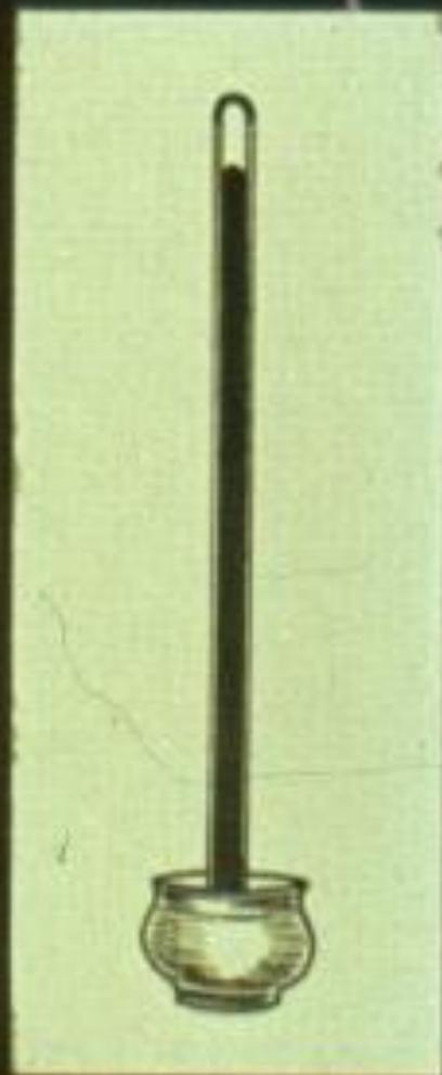
Трубка Торричелли была первым барометром. Чашечный барометр—это её усовершенствованный вариант.
