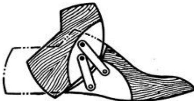
Рис. 8.3. Конструкции раздвижных колодок
