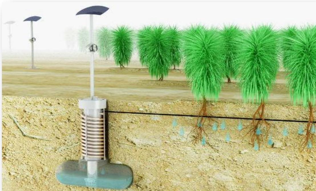
Система Airdrop (Австралия) имеют небольшую ветротурбину на входе системы загоняющую воздух по вертикальной трубе в спрятанную ниже уровня грунта в медную трубку-конденсатор, где температура воздуха быстро падает, и на стенках трубки, а также на поверхности теплообменной спирали появляются капли воды.
