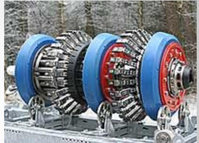
Комбинированная измерительная технология, используемая в снаряде XGP, делает снаряд менее чувствительным к состоянию внутренней стенки трубы и позволяет записать более точные данные даже при наличии отложений парафина и загрязнений. Также снаряд XGP позволяет определять пространственные координаты трубопровода XYZ.
