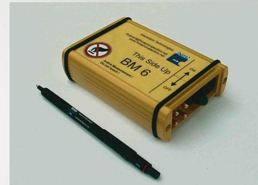
Перед пропуском магнитного инспекционного снаряда в заранее намеченных местах раскладываются электронные маркеры BM6.
