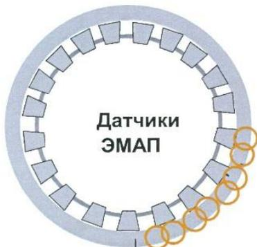
Расположение датчиков, обеспечивающее высокое разрешение
