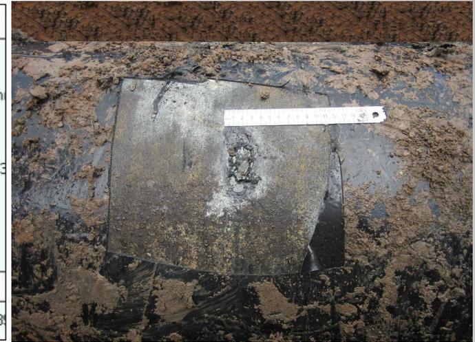
Местоположение дефекта определяется по координатам ближайшего угла условного прямоугольника, обрисовывающего дефект, против течения. В этом прямоугольнике зона, выбранная для контрольной проверки, определяется по внешним размерам, как указано в Паспорте дефекта. Эта зона должна быть увеличена с учетом погрешности при поиске на месте и погрешности, указанной в отчете.
