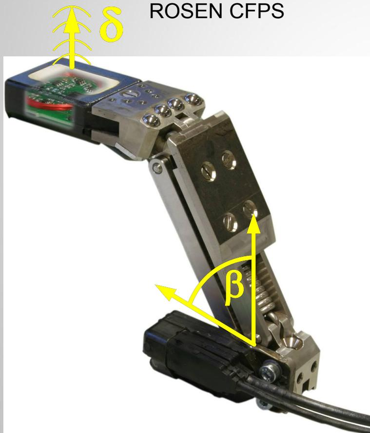
Измерение формы внутренней поверхности
