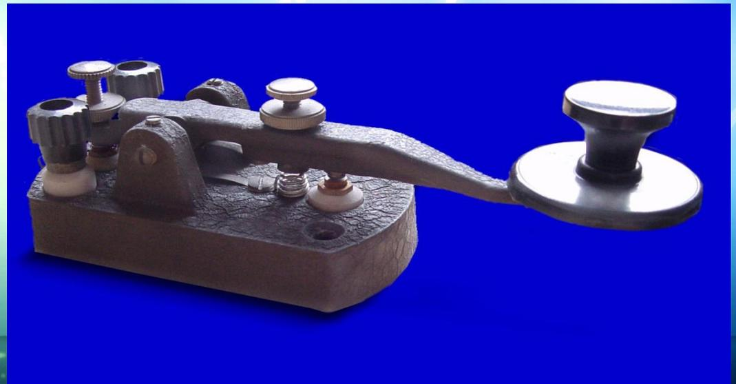
Il code toutes les lettres de l'alphabet et les chiffres avec des points et des tirets. L'appareil de Morse est assez simple. Il utilise la circulation du courant électrique dans un fil de fer.
