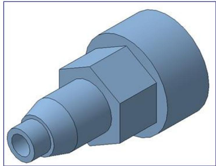
Объединив все части, устанавливаем общую форму предмета. Она представляет собой сочетание цилиндров, усеченного конуса и шестиугольной призмы, расположенных на одной оси. Вдоль оси детали проходит сквозное цилиндрическое отверстие.
