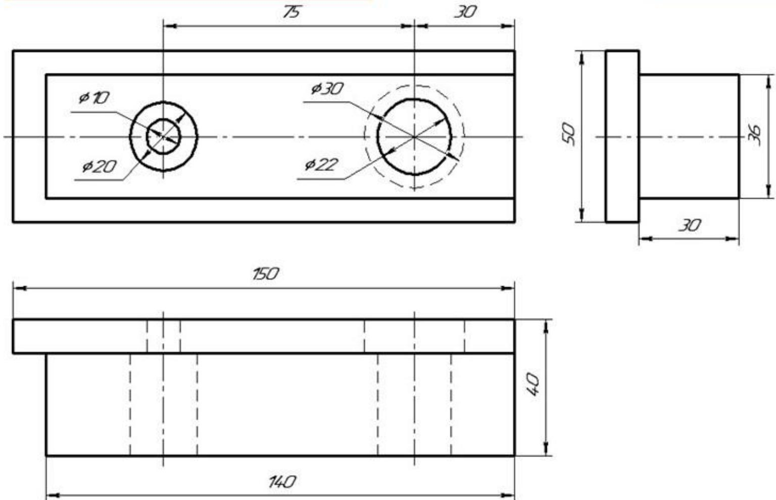
**5. Опишите форму детали?** Форма детали образована: из двух параллелепипедов, из двух цилиндрических отверстий и из двух цилиндрических углублений.
