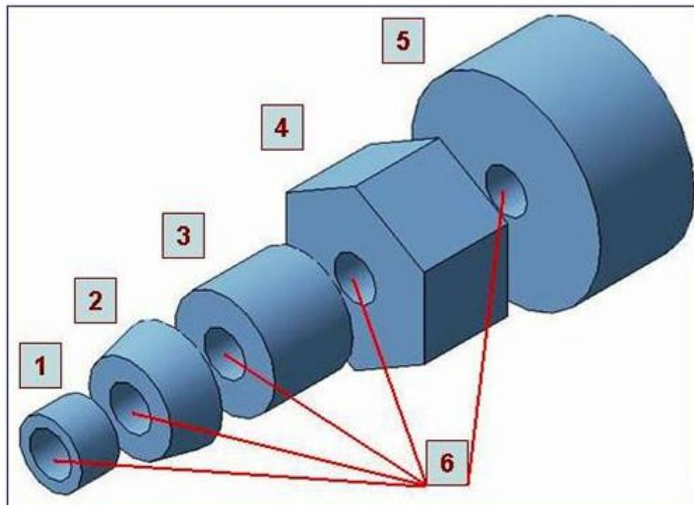
Деталь представляет собой сочетание цилиндров (1, 3, 5), усеченного конуса (2) и шестиугольной призмы (4), расположенных на одной оси. Вдоль оси детали проходит сквозное цилиндрическое отверстие (6).
