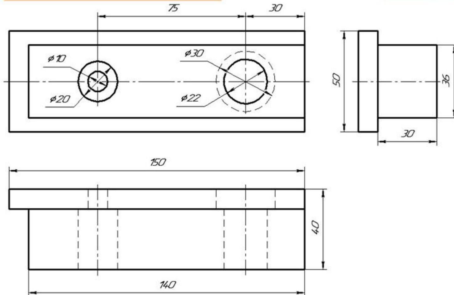
**4. Сочетанием каких геометрических тел образована ее форма?** Форма детали образована: из двух прямоугольных параллелепипедов, из двух сквозных цилиндрических отверстий и из двух глухих (несквозных) цилиндрических отверстий (углублений).
