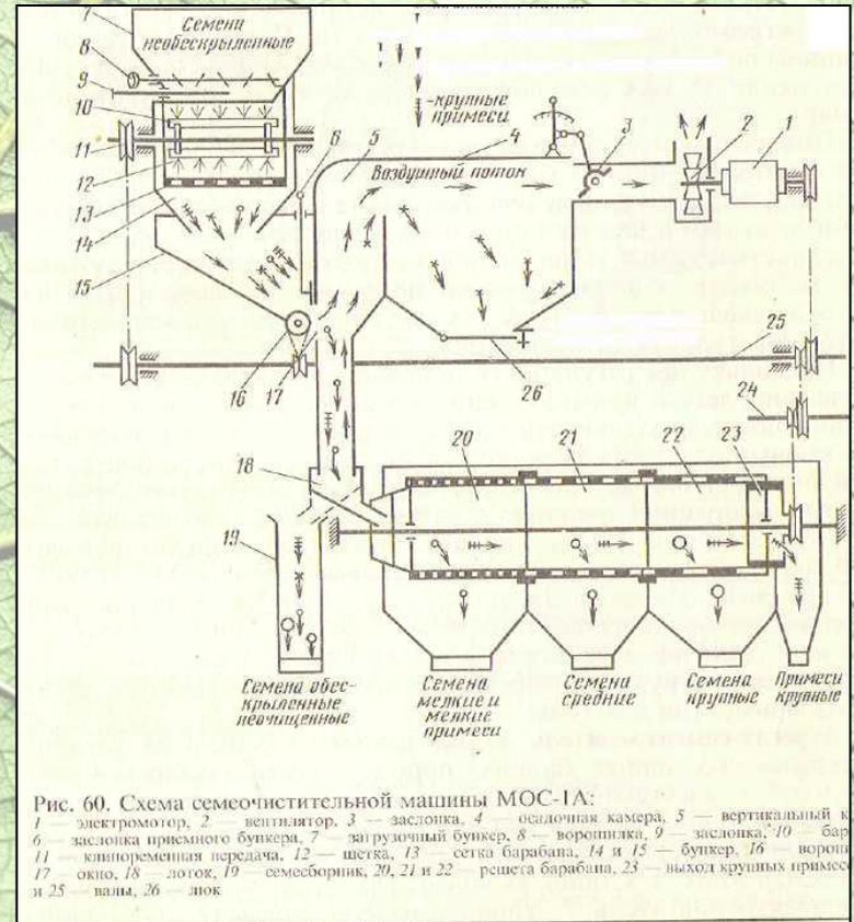
Рис. 60. Схема семяочистительной машины МОС-1А:
