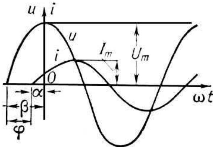
При наличии в цепи переменного тока активного, индуктивного и емкостного сопротивлений разность фаз между колебаниями силы тока и напряжения равна  $\varphi$
