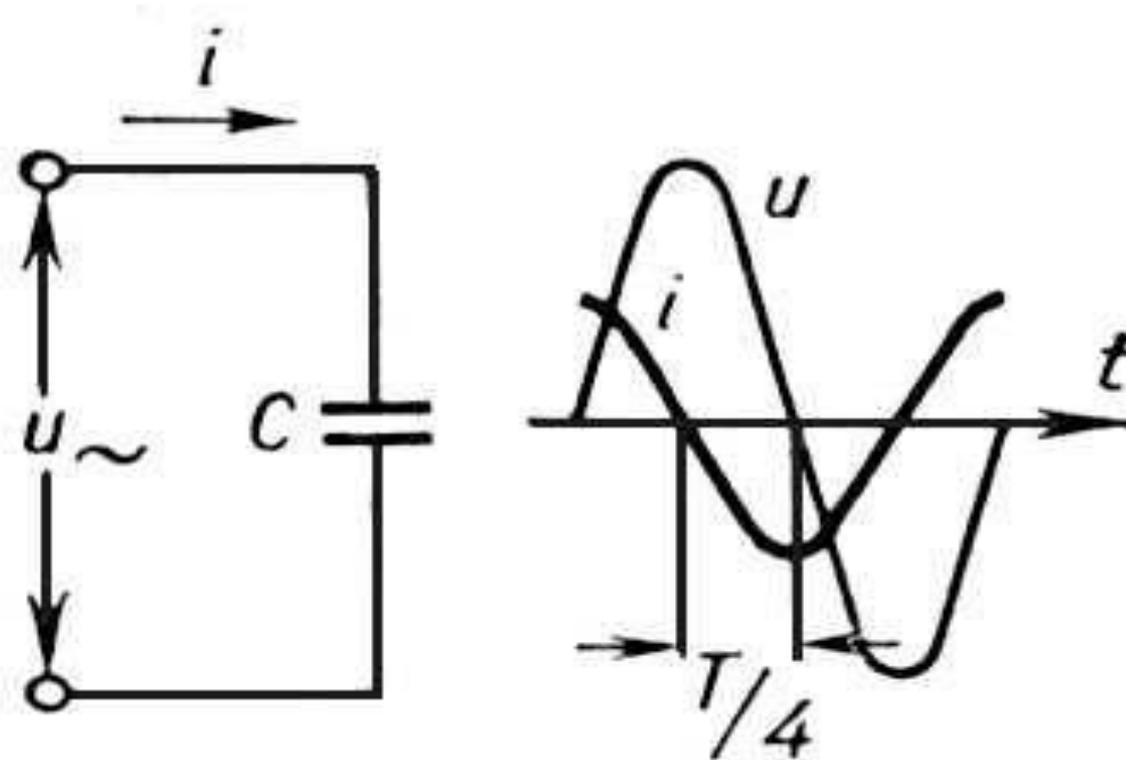
**Колебания силы тока на конденсаторе опережают колебания напряжения по времени на четверть периода, а по фазе на**
