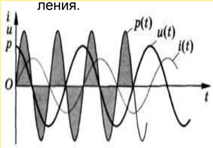
Из этого графика видно, что в течение одной четверти периода мощность положительна и энергия от сети поступает к данному участку цепи; но в течение следующей четверти периода мощность отрицательна, и данный участок отдает без потерь обратно в сеть полученную ранее энергию. Поступающая в течение четверти периода энергия запасается в магнитном поле тока, а затем без потерь
