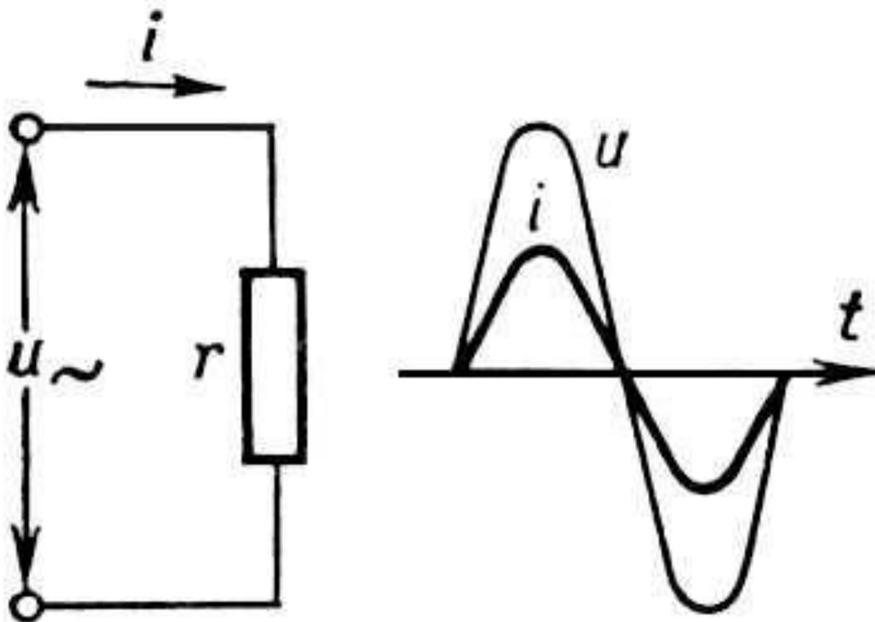
**Колебания силы тока и напряжения на активном сопротивлении происходят в одной и той же фазе, разность фаз колебаний равна нулю.**
