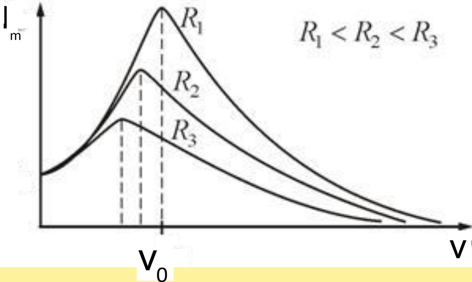
**Электрический резонанс** – резкое увеличение силы тока в контуре при приближении частоты внешнего воздействия к собственной частоте колебаний контура. Явление электрического резонанса исследовал Никола Тесла (1856-1943), сын сельского священника из Хорватии. Он некоторое время учился у Эдисона, но потом быстро отделился. Именно ему принадлежат такие слова:
