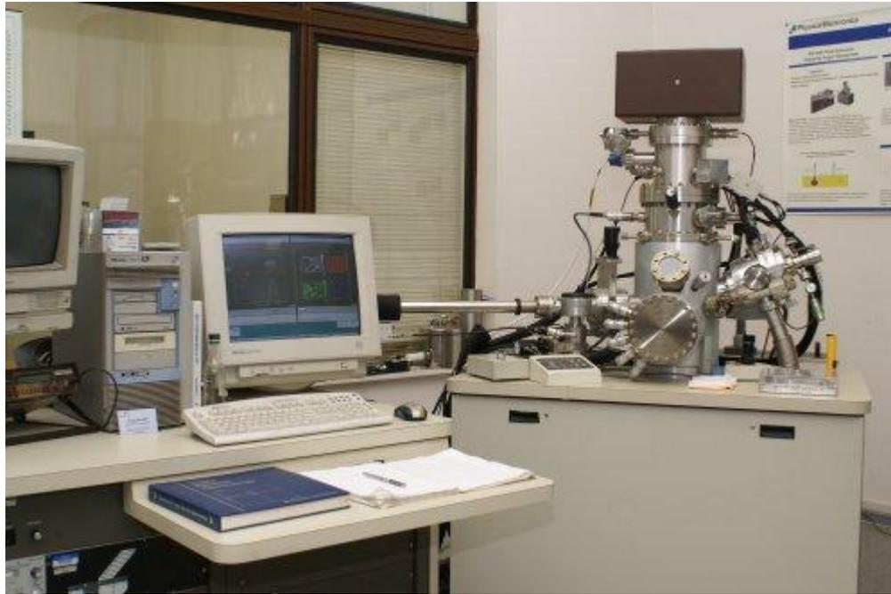
ЭЛЕКТРОННЫЙ ОЖЕ-СПЕКТРОМЕТР PHI-680
