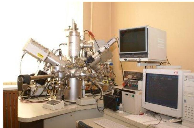
ВТОРИЧНЫЙ ИОННЫЙ МАСС-СПЕКТРОМЕТР PHI-6600 фирмы "PERKIN ELMER"
