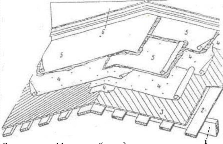
Рисунок 2.25 Мягкая рубероидная кровля: 1 – стропильная нога; 2 – обрешетка; 3 – косой дощатый настил; 4 – пергамин на гвоздях; 5 – рубероид на мостика; 6 – борт кровли
