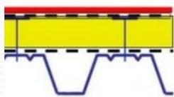
Система с механическим креплением
