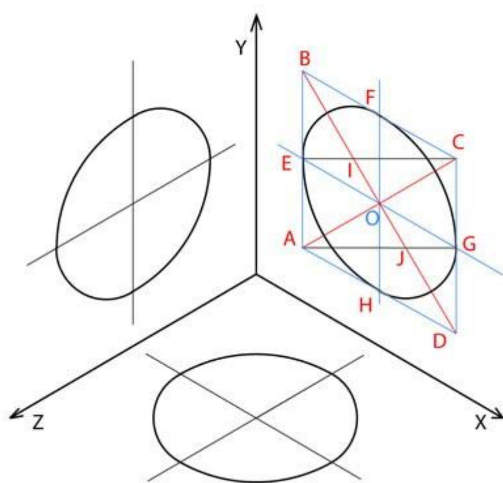
6. Последовательно обозначьте точки, в которых линии параллельные осям проекции пересекают стороны ромба буквами E, F, G и H. Точка E должна следовать за точкой A в том же направлении, в котором последовательно обозначались углы ромба.
