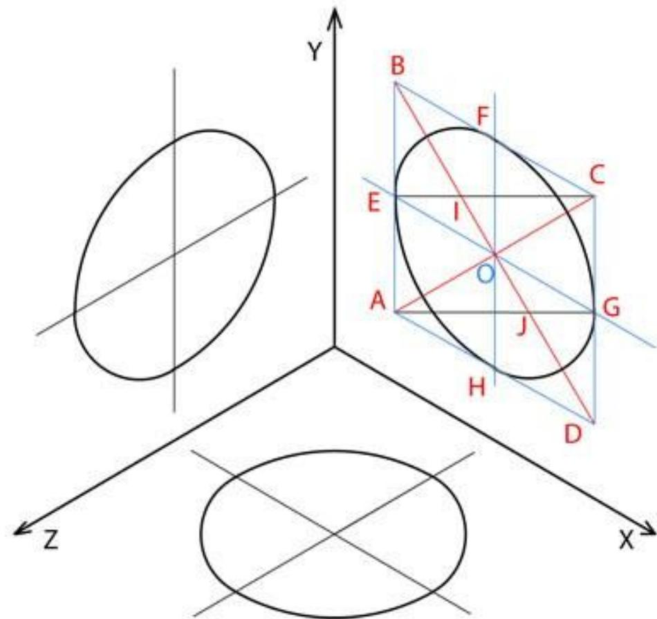
9. С помощью циркуля начертите дугу между точками E и F. Центр окружности для дуги расположен в точке I, а её радиус равен длине отрезка EI. Аналогично начертите дугу между точками G и H.
