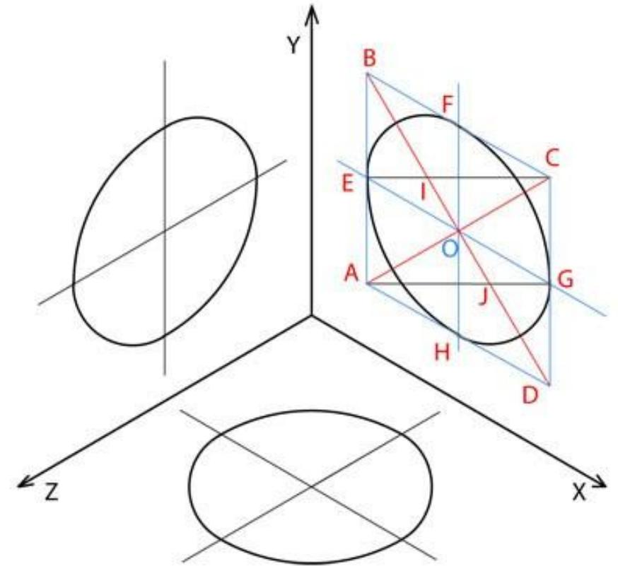
3. Начертите диагонали получившегося ромба, соединив отрезками точки А и С, а также В и D. Диагональ АС образует малую ось овала, а диагональ ВD - большую.
