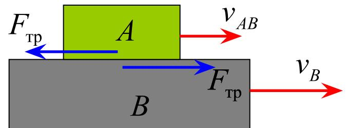
Полная мощность внутренних сил трения скольжения двух сочлененных тел равна взятому со знаком минус произведению модуля силы трения на модуль относительной скорости.
