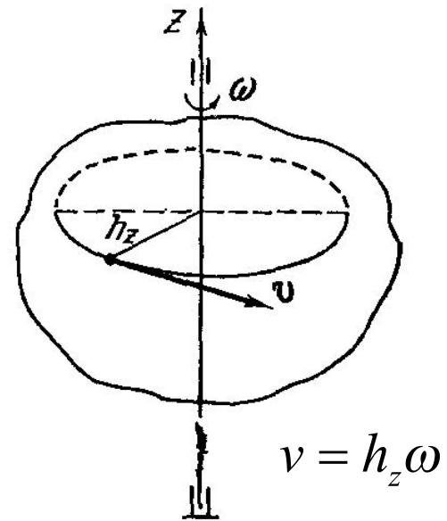
кинетическая энергия ТТ, вращающегося вокруг неподвижной оси, равна половине произведения момента инерции тела относительно оси вращения на квадрат угловой скорости тела
