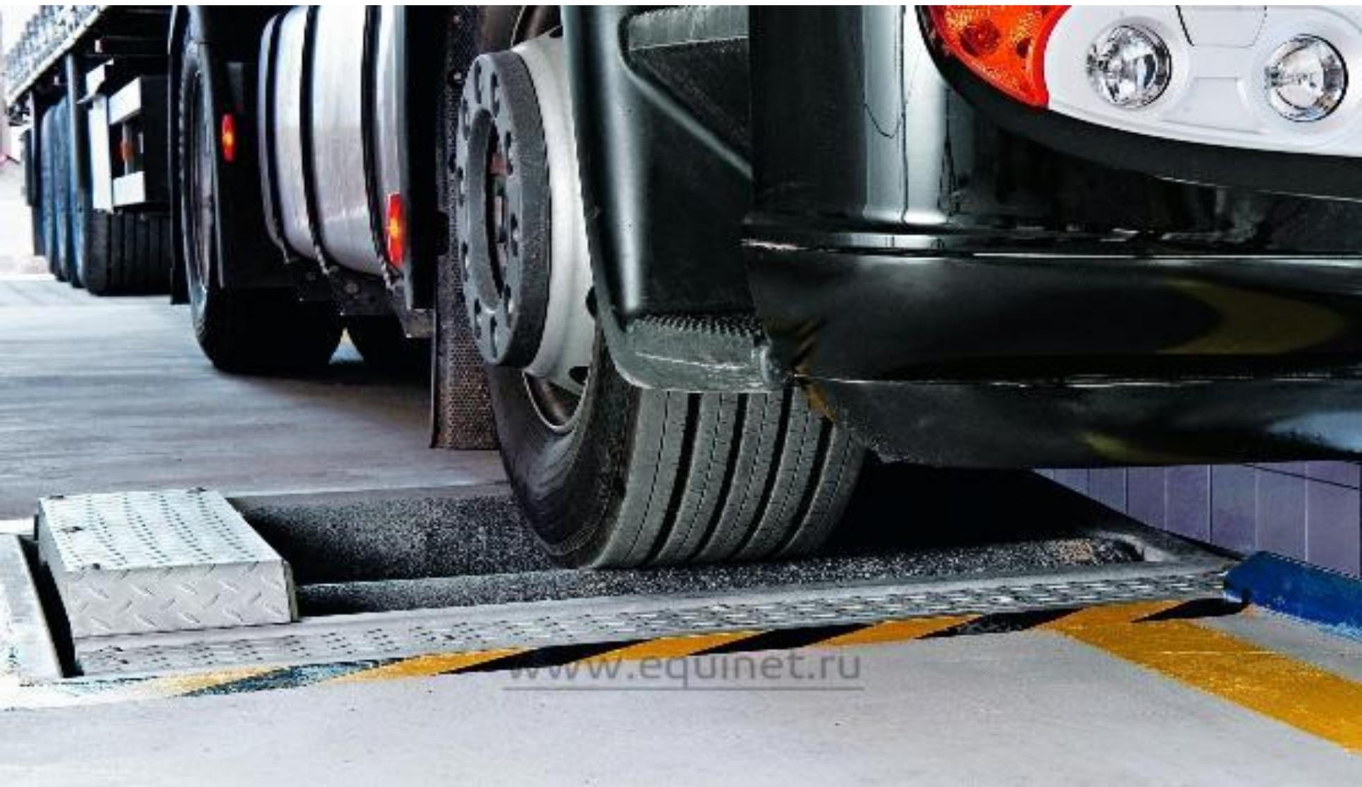
Для этих целей используются стенды с беговыми барабанами или параметры определяются непосредственно в процессе работы автомобиля на линии
