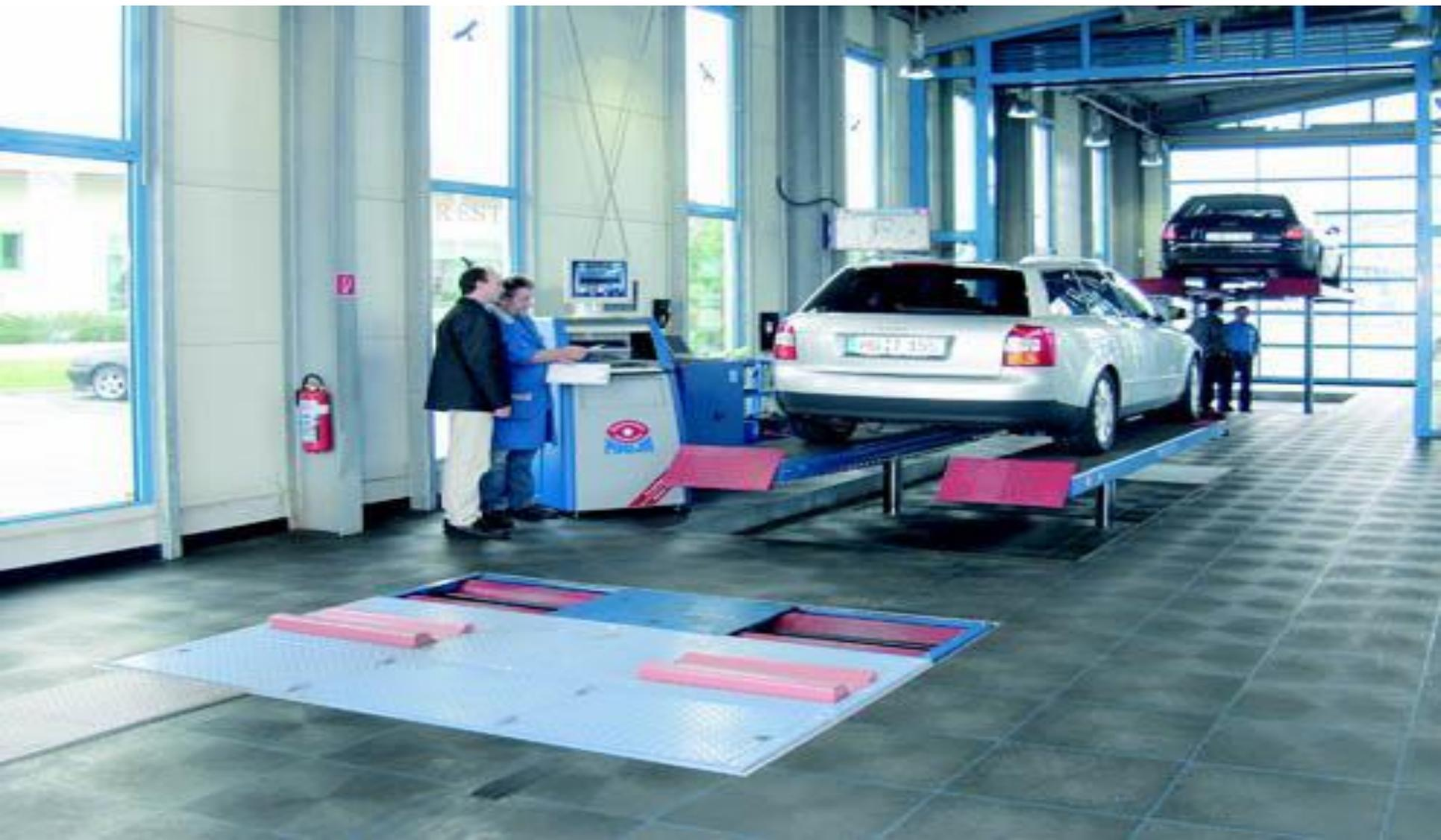
*Первая группа* средств базируется в основном на имитации скоростных и нагрузочных режимов работы автомобиля и определении при заданных условиях выходных параметров
