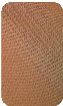
**Симплекс** – общий термин, используемый для обозначения осново-трикотажного полотна, которое ткется на основовязальной машине «симплекс». В результате получается двустороннее трикотажное полотно. Ткани симплекс имеют гладкую поверхность и очень хорошо тянутся в любом направлении.
