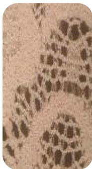
**Рашелевое кружево** – родовой термин для основовязанной кружевной ткани, изготовленной на рашелевой основовязальной машине. Это самый дешевый способ производства разнообразного кружева, от тонкого и прозрачного, до плотного и тяжелого.
