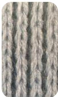
**Эластичное полотно** - уточная трикотажная ткань, изготовленная на основе 1x1 двойного трикотажного переплетения. Различают два вида такой ткани: переплетение «кардиган» (фанг) и переплетение «полукардиган» (ластичный полуфанг). Такая ткань может быть изготовлена из пряжи любого вида.
