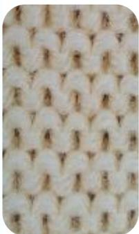
**Перл** – это любая уточная трикотажная ткань, основанная на двухизнаночном переплетении. Перл обычно достаточно толстый, эластичный в длину, причем и с лицевой, и с изнаночной стороны видны только изнаночные петли.
