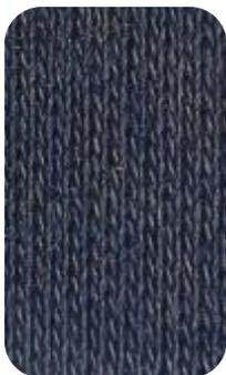
**Жаккард** – разновидность уточного трикотажа, который производится на уточно-вязальной машине с использованием жаккардового механизма.
