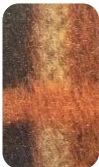
**Флисовая ткань** – это мягкая теплая ткань с ворсистой поверхностью и хорошими термоизолирующими свойствами. Большинство уточных трикотажных флисовых тканей односторонние и производятся с использованием полотняного переплетения с дополнительными разделительными нитями с изнаночной стороны. В качестве дополнительных нитей используется отлогая пряжа, которая обычно толще грунтовой основной пряжи.
