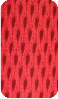
**Сетчатая ткань** – основной термин, объединяющий широкий спектр разнообразных тканей, вязанных, тканых или ажурных, которые имеющих сетчатую структуру, характеризующуюся наличием отверстий и пробелов между нитями. Это позволяет воздуху свободно проходить через ткань, делая ее прохладной и комфортной в ношении при соприкосновении с кожей. Для изготовления данного вида ткани используются как натуральные, так и искусственные волокна.
