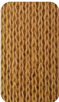
**Пикет** – уточный двойной джерси, изготовленный на основе структуры интерлока. Структура ткани одинакова с обеих сторон.
