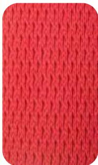
**Пике (основосвязанный)** - тип сетчатой ткани с выраженным мешкообразным узором по направлению основы. Основовязанный пике обычно изготавливается при помощи двух ведущих фонтур. Впалые ряды между полосами образуются путем пропуска одной или более нитей задней ведущей фонтурой, вследствие чего получают маленькие ложбины.
