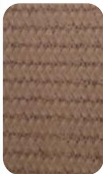
**Ткань «фризе»** - основовязанная ткань, изготовленная из нейлона или полиэстера, с низким ворсом на одной из поверхностей. Такая ткань изначально являлась более дешевой альтернативой лопрезу, поэтому эти две ткани очень похожи.
