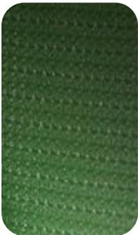
**Локнит** – прочная, плотно связанная ткань. Существует как уточная, так и основовязанная ткань. Это одна из самых распространенных основовязанных тканей. Изготавливается из искусственных тканей, часто имеет в составе эластан для повышения эластичности. Ткань не распускается, хорошо тянется, она непрозрачна и имеет гладкую мягкую поверхность, что позволяет делать из нее разнообразные эластичные ткани. Локнит изготавливается на одновязальной машине.
