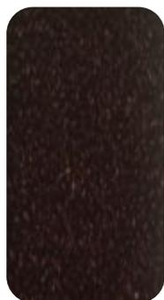
**Букле** – основосвязанная ткань, имеющая в своей структуре низкий ворс с одной стороны. Таким образом получается легкая тонкая ткань с текстурированной поверхностью.
