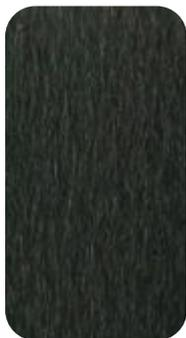
**Лопрез** – основовязанный трикотаж, изготавливается с использованием нейлоновых или полиэстровых нитей прочесанных на одной из сторон с образованием ворсистой поверхности, что делает ткань намного теплее, чем непрочесанные варианты. Такая ткань легка в уходе и служит длительный срок.
