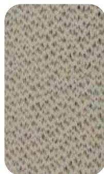
**Креп** – ткань с шероховатой поверхностью, однородная либо в рубчик, изготовленная с использованием трикотажного переплетения, образуемого чередованием кулированных петель и подкладных нитей или кулирующими и запрессованными иглами, которые прокладываются в предварительно установленном неориентированном порядке.
