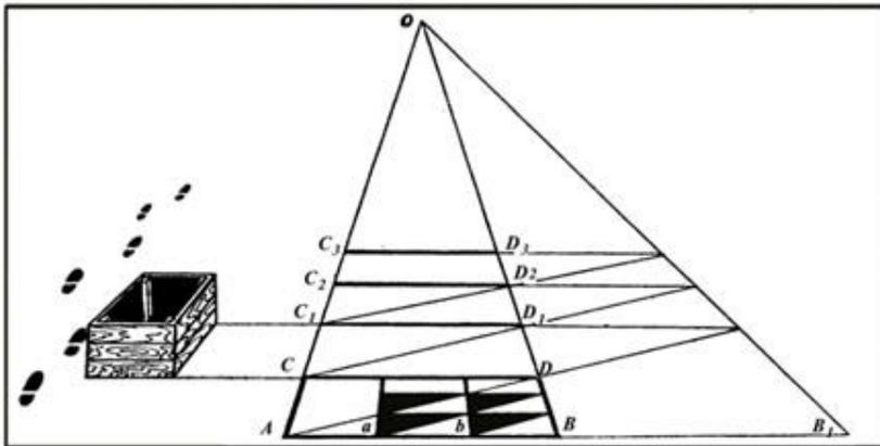
Схема определения размеров по фотоснимку, выполненному с метрическим квадратом
