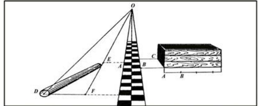
Схема определения размеров по фотоснимку, выполненному с глубинным масштабом перспективно-горизонтальным способом
