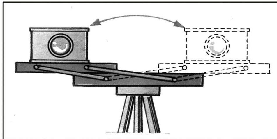
Приспособление для съёмки стереопар одним аппаратом с постоянным базисом
