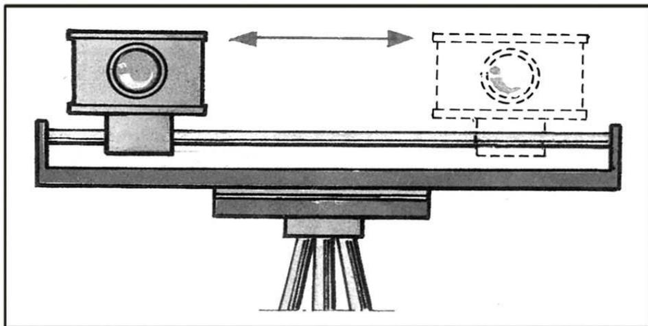
Приспособление для съёмки стереопар одним аппаратом с переменным базисом
