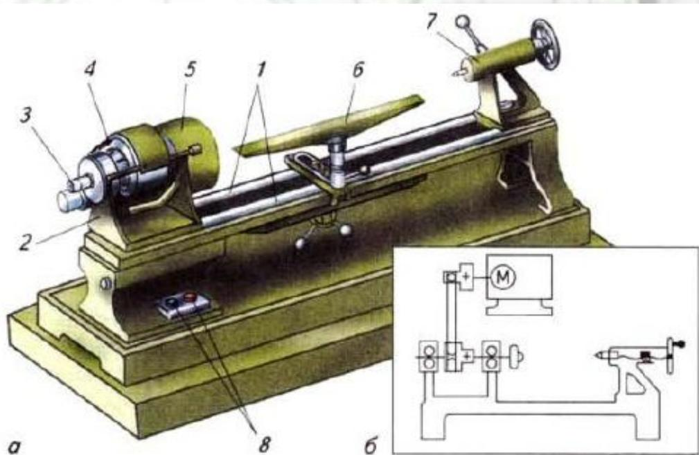
Схема токарного станка для обработки древесины ТД-120
