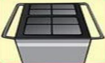
Плита должна иметь бортовую поверхность и поручни, предохраняющие от ожогов. Поручни должны быть расположены от бортов плиты на расстоянии не ближе 10 см
