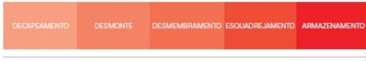
Figura 21: Fluxograma da extração do granito
