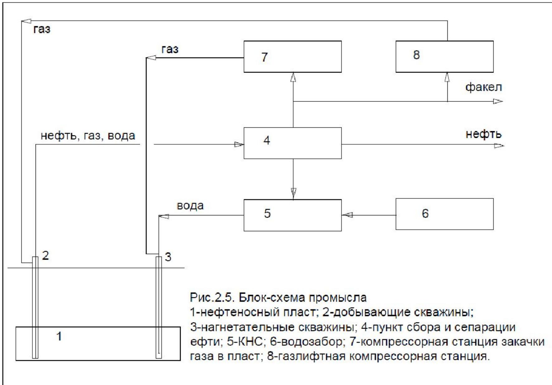
На рис. 2.5. представлена блок-схема основных сооружений промысла.
