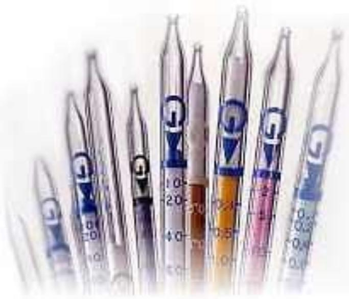
**Индикаторные трубки — широко используемые средства экспресс-анализа загрязненности воздуха, воды, почвы промышленными и технологическими выбросами по ГОСТ 12.1.014-84.**
