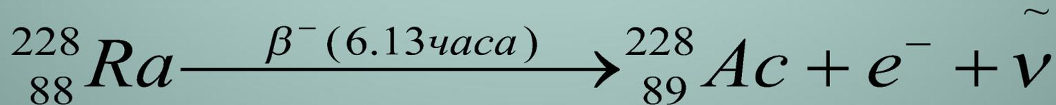
**Бета** - излучение - корпускулярное излучение с непрерывным энергетическим спектром, состоящее из отрицательно или положительно заряженных электронов или позитронов ( $\beta$ - или  $\beta$ + частиц) и возникающее при радиоактивном  $\beta$  - распаде ядер или нестабильных частиц. Характеризуется граничной энергией спектра  $E_{\beta}$ .
