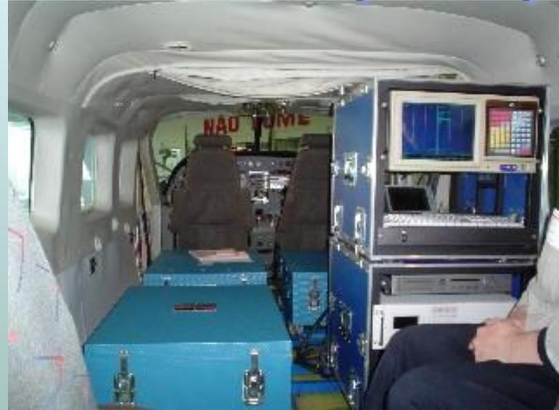
Аэро-гаммаспектрометрическая съемка является дистанционным геохимическим видом поисков, поскольку позволяет быстро и с высокой степенью точности определять в поверхностном слое коренных пород энергию гамма-излучения, связанного с распадом калия, тория и урана. Соотношения этих элементов позволяют экспрессно выявлять месторождения литофильных (U, TR, Nb, Zr, Sn) и халькофильных (Au, Ag, Mo, Cu, Bi) элементов.
