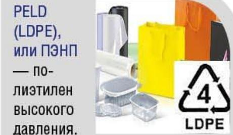
**PELD (LDPE), или ПЭНП** — полиэтилен высокого давления. Используется в производстве полиэтиленовых пакетов, гнующихся пластиковых упаковок и для производства некоторых пластиковых бутылок. Хорошо поддается переработке и вторичному использованию.
