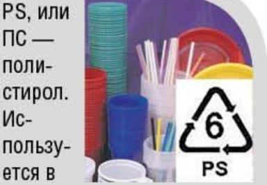
**PS, или ПС** — полистирол. Используется в производстве поддонов для мяса и птицы, контейнеров для яиц, в строительной индустрии — теплоизоляционные плиты, сандвич панели, потолочный багет, потолочная плитка.
