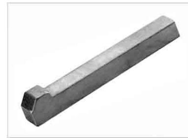
Шпонки изготавливают из сталей, имеющих временное сопротивление на разрыв не менее 590 МПа (наиболее часто используется стали 45 и 50) с твердостью (30-40) HRC
