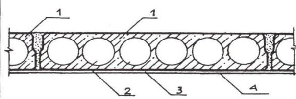
1 — усиливаемые плиты; 2 — очищенная и обезжиренная поверхность плит; 3 — защитно-конструкционный полимерраствор; 4 — листовой металл (очищенный от окалины и ржавчины и обезжиренный ацетоном) или несколько слоев стеклоткани марок СТ-11, СТ-13 или стеклосетки марок РС<sub>2</sub>-1, РС<sub>2</sub>-2 и др. (очищенные от замазывания)
