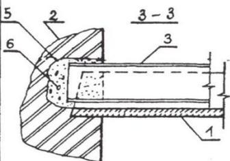
1 — усиливаемые плиты; 2 — кирпичная стена; 3 — металлические балки из двутавров; 4 — вырубленные полки плит для установки балок; 5 — вырубленные ниши в стенах для заведения балок; 6 — бетон замоноличивания вырубленных полок, ниш и пустот
