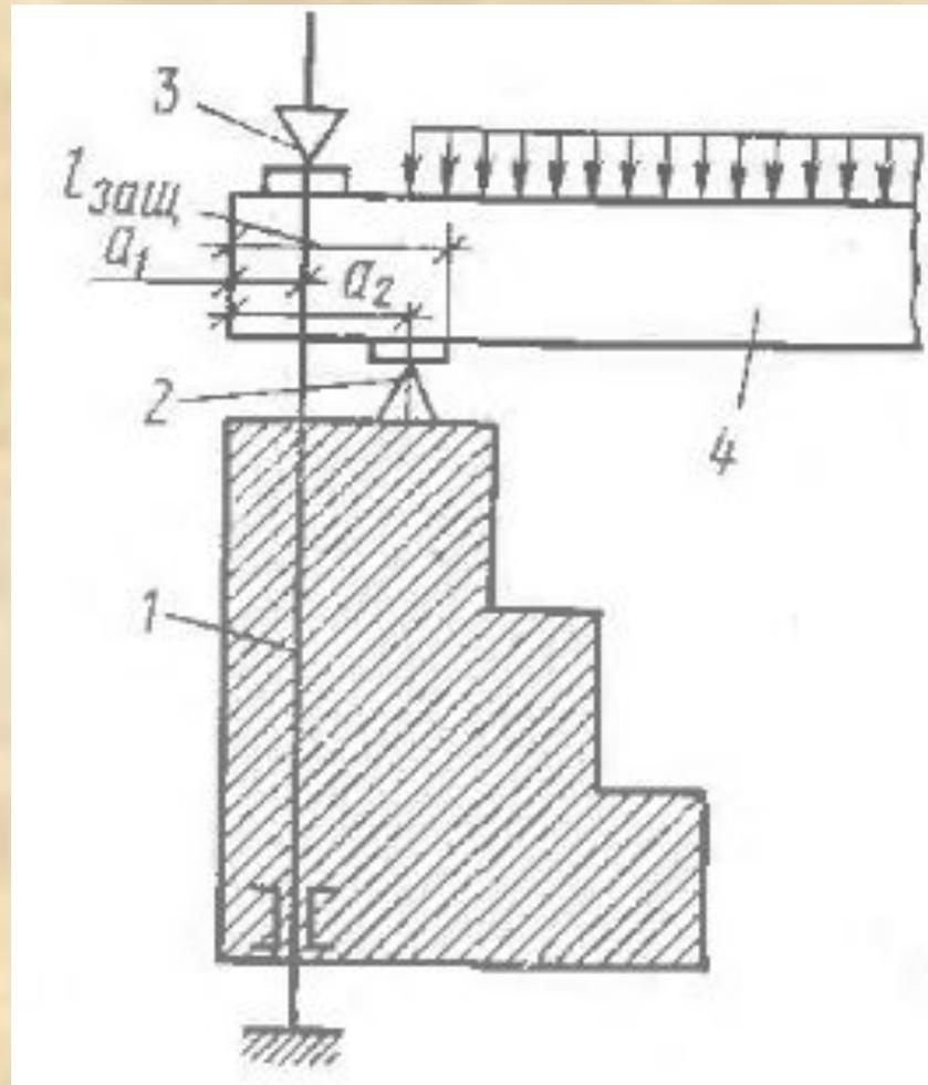
**Рис. 8.3. Схема испытания заземленной консоли**
