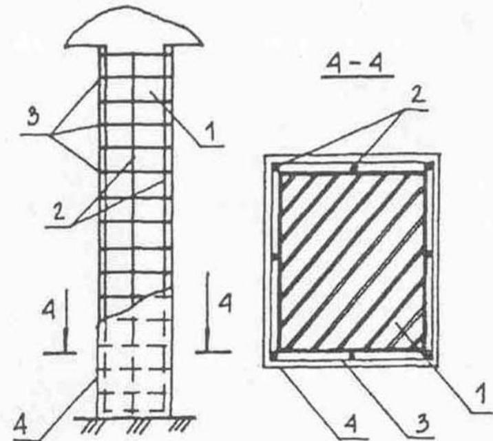
1 – усиливаемый столб (простенок); 2 – стержни диаметром 6–12 мм; 3 – хомуты диаметром 3–6 мм; 4 – раствор марки 75–100
