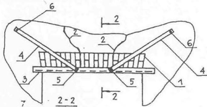
1 – усиливаемая перемычка; 2 – трещины в перемычке; 3 – накладки из уголка, устанавливаемые на цементно-песчаном растворе; 4 – тяжи из полосовой стали; 5 – крепежные болты; 6 – анкерные болты; 7 – отверстия в стене (после установки болтов зачеканиваются раствором)
