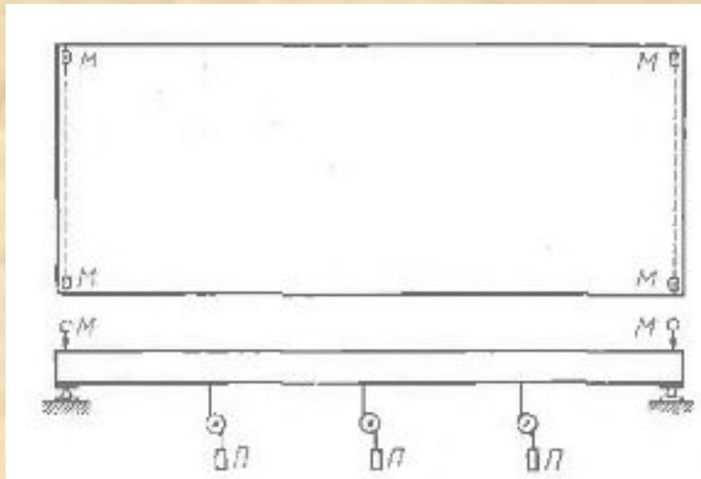
**Рис. 8.10. Схема испытания панели перекрытия и расстановка измерительных приборов**
