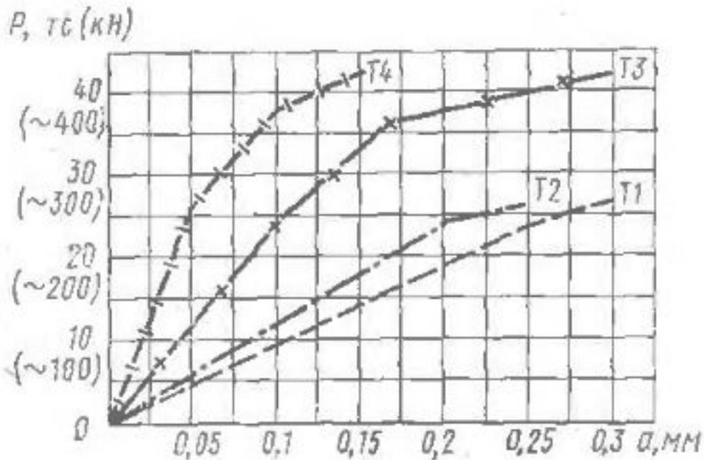
**Рис. 8.16. График нарастания ширины раскрытия трещины от нагрузки**
