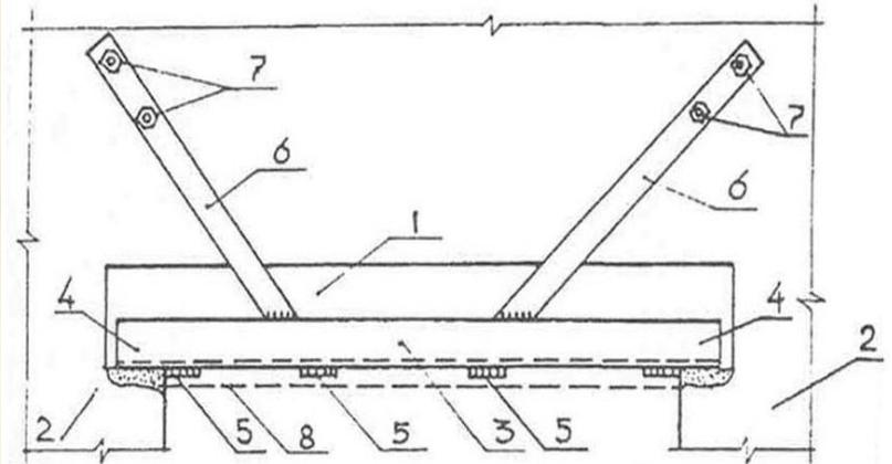
1 – усиливаемые перемычки; 2 – кирпичные простенки; 3 – разгружающие балки из уголка; 4 – заделка уголков в простенки; 5 – соединительные планки на сварке; 6 – подвески из металлической полосы, приваренные к уголкам; 7 – анкерные болты, установленные в отверстиях, просверленных в стене; 8 – штукатурка по сетке
