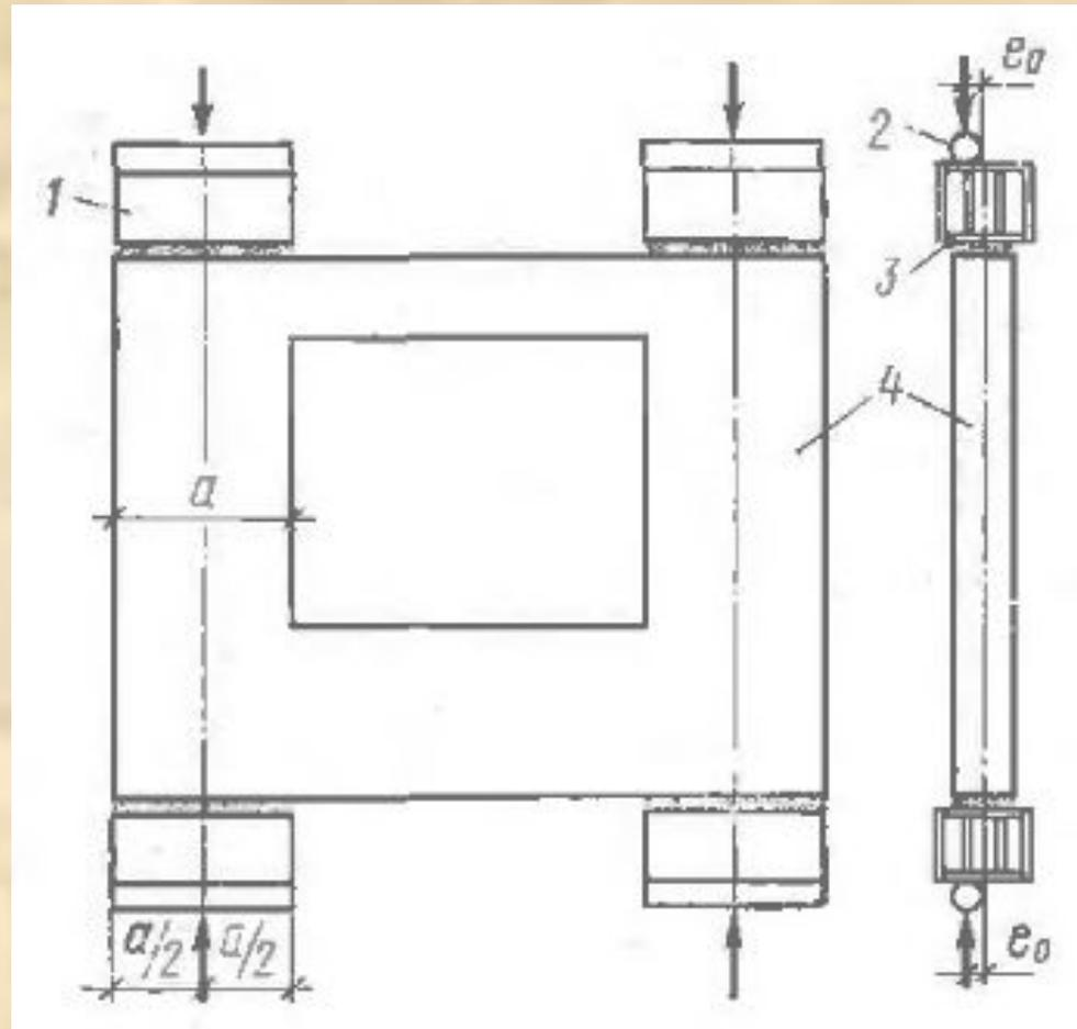
**Рис. 8.6. Схема испытания стеновой панели с оконным проемом на внецентренное сжатие при эксцентриситете  $e_0$**
