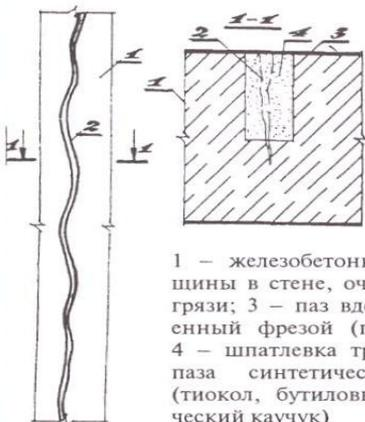
1 — железобетонная стена; 2 — трещины в стене, очищенные от пыли и грязи; 3 — паз вдоль трещины, устроенный фрезой (при необходимости); 4 — шпатлевка трещины устроенного паза синтетическими материалами (тиокол, бутиловый каучук, синтетический каучук)
