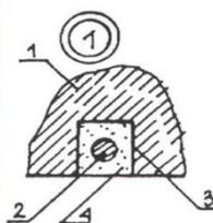
1 — усиливаемые плиты; 2 — дополнительная арматура; 3 — пазы в бетоне, вырезанные фрезой; 4 — защитно-конструкционный полимерраствор
