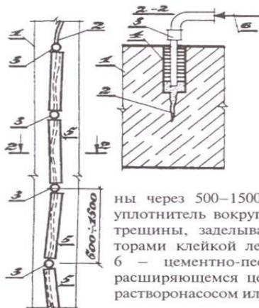
1 — железобетонная стена; 2 — трещины в стене, очищенные от пыли и грязи; 3 — иньектор (стальная трубка), устанавливаемый в высверленные скважины вдоль трещины через 500–1500 мм; 4 — резиновый уплотнитель вокруг иньектора; 5 — верх трещины, заделываемый между иньекторами клеевой лентой или раствором; 6 — цементно-песчаный раствор (на расширяющемся цементе), нагнетаемый растворомасосом или ручным шприцем
