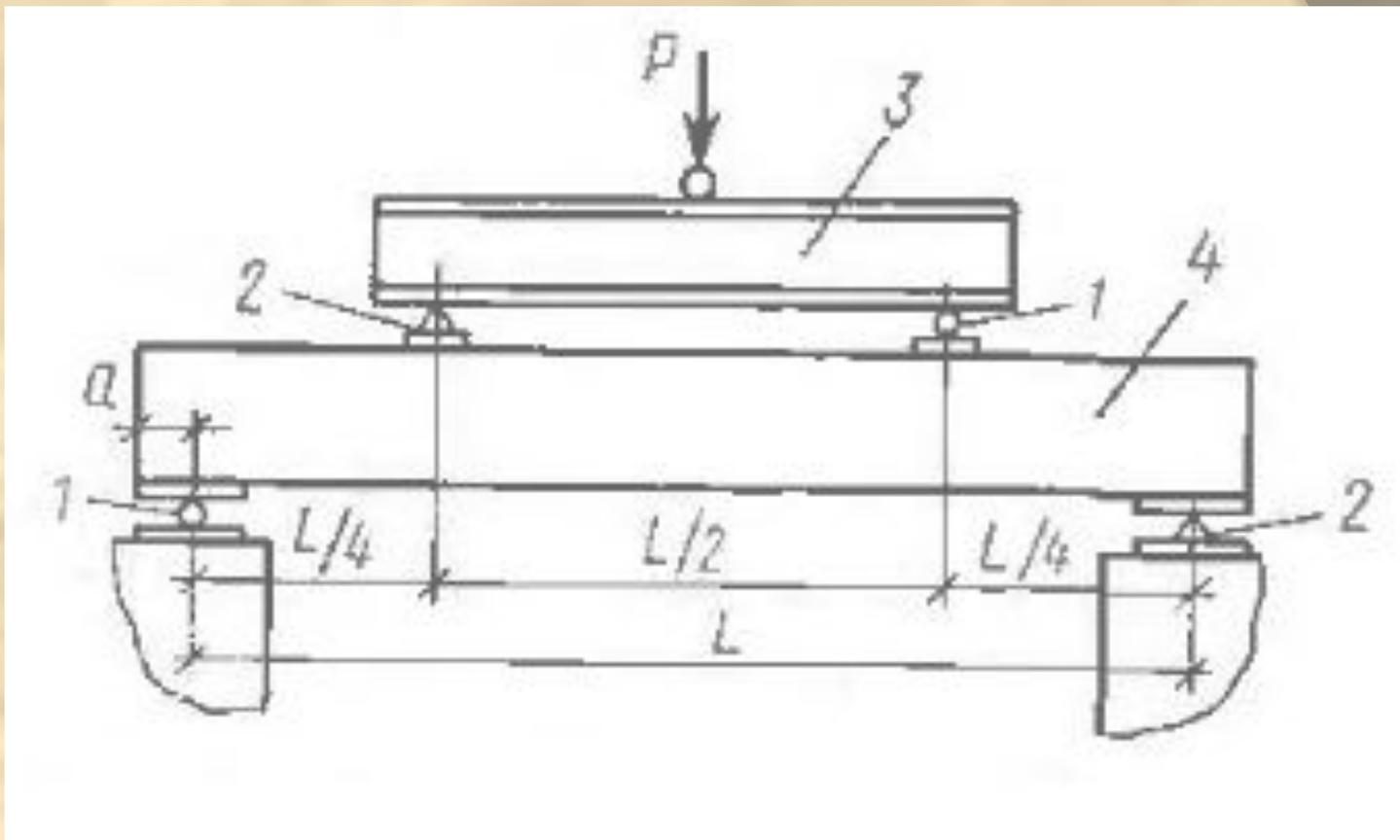
**Рис. 8.2. Схема испытания балки на двух опорах**
