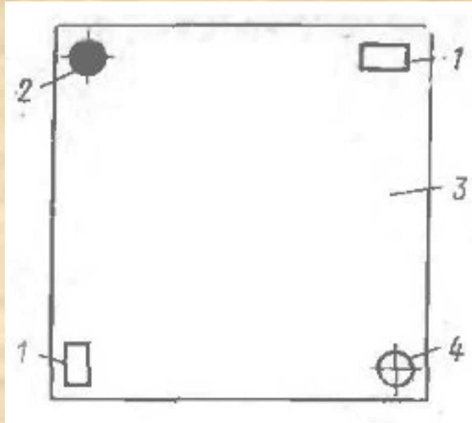
**Рис. 8.4. Схема опирания плиты по четырем углам**
