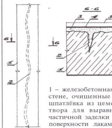
1 — железобетонная стена; 2 — трещины в стене, очищенные от пыли и грязи; 3 — шпатлевка из цементно-песчаного раствора для выравнивания поверхности и частичной заделки трещин; 4 — грунтовка поверхности лаками (эпоксидными, перхлорвиниловыми); 5 — лакокрасочное покрытие (2 и более слоев эмали эпоксидной, перхлорвиниловой, хлоркаучуковой, хлорсульфированного полиэтилена и др.)
