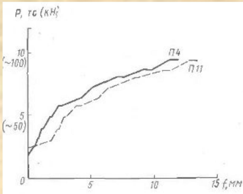
**Рис. 8.12. График зависимости прогибов конструкции от нагрузки**
