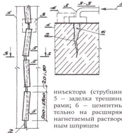
1 — железобетонная стена; 2 — трещины в стене, очищенные от пыли и грязи; 3 — иньектор поверхностного типа (тупиковый, вакуумный, циркуляционный); 4 — крепление иньектора (струбины, болты и др.); 5 — заделка трещины между иньекторами; 6 — цементный раствор (желательно на расширяющемся цементе), нагнетаемый растворомасосом или ручным шприцем
