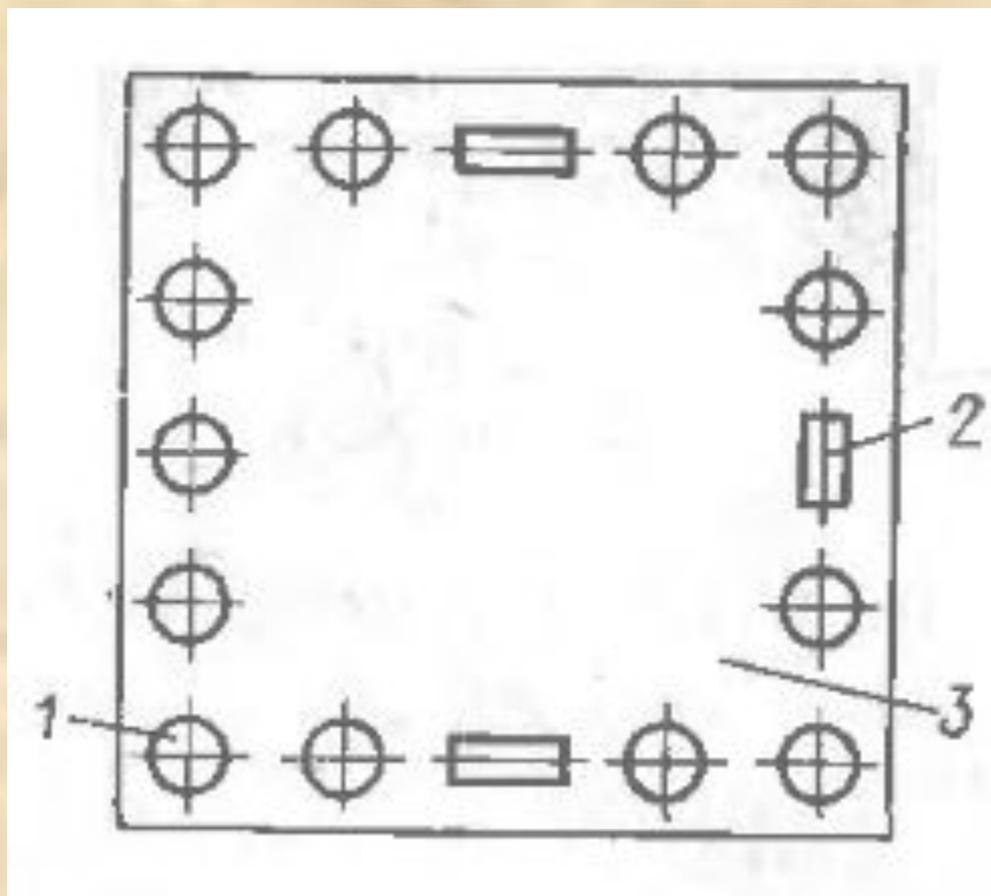
**Рис. 8.5. Схема опирания плиты по контуру**
