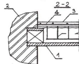
1 — усиливаемая плита; 2 — кирпичная стена; 3 — монолитный слой бетона; 4 — арматурная сетка; 5 — арматурные каркасы; 6 — вырубленные полки плит для установки каркасов; 7 — поверхность сцепления монолитного бетона с плитами; 8 — бетон замоноличивания вырубленных полок и пустот
