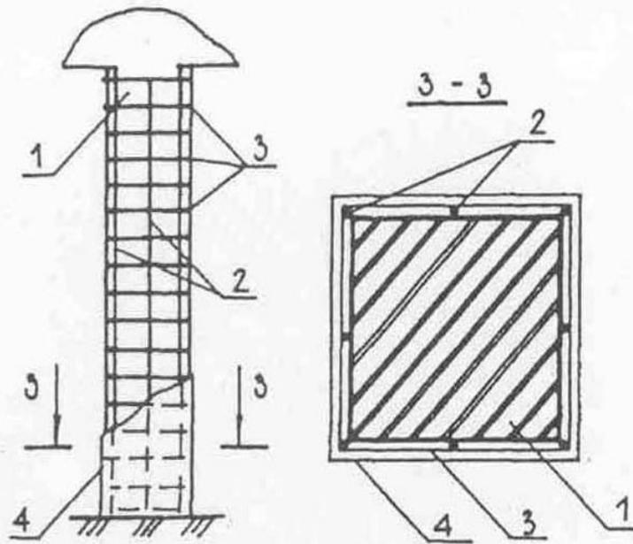
1 – усиливаемый столб (простенок); 2 – стержни диаметром 12 мм; 3 – хомуты диаметром 5–6 мм; 4 – бетон класса В15
