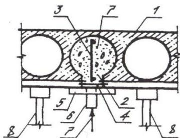
1 — усиливаемая железобетонная плита; 2 — щели, прорезанные по пустотам со стороны потолка; 3 — арматурные каркасы, устанавливаемые через прорезанные щели в пустоты; 4 — арматурные коротыши для крепления каркасов к оголенной арматуре плиты; 5 — щит опалубки, устанавливаемый на щели; 6 — штуцер, установленный в опалубке для закачивания бетонной смеси; 7 — бетонная смесь, закачиваемая в пустоты; 8 — временные разгружающие стойки (снимаются после набора бетоном прочности)
