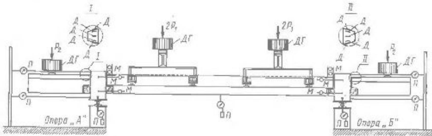
**Рис. 8.8. Схема испытания узла сопряжения ригеля с фрагментами колонн с консолями и расстановка измерительных приборов**
