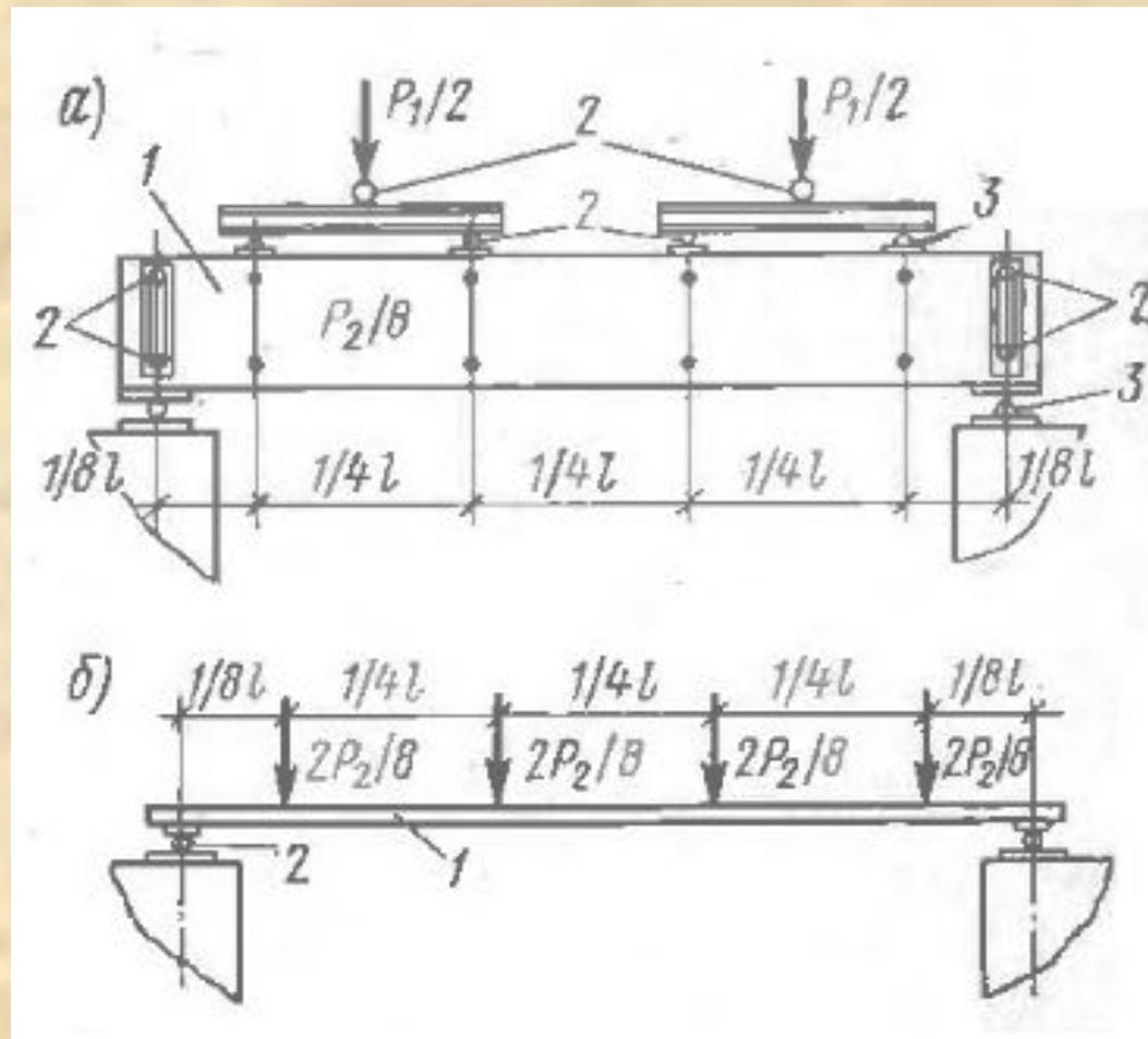
**Рис. 8.7.** Схема испытания стеновой панели при одновременном действии вертикальных (а) и горизонтальных (б) нагрузок
