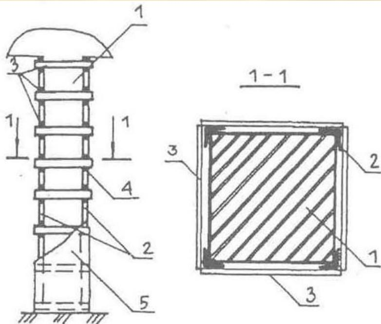
1 – усиливаемый столб (простенок); 2 – уголки обоймы; 3 – поперечные планки обоймы; 4 – сварка; 5 – штукатурка цементно-песчаным раствором
