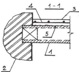
1 — усиливаемые плиты; 2 — кирпичная стена; 3 — монолитный слой бетона; 4 — арматурная сетка; 5 — поверхность сцепления монолитного бетона с плитами (зачистка, насечка, промывка водой)
